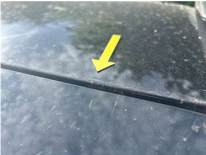
Dach (Lackschaden, Steinschlag)
