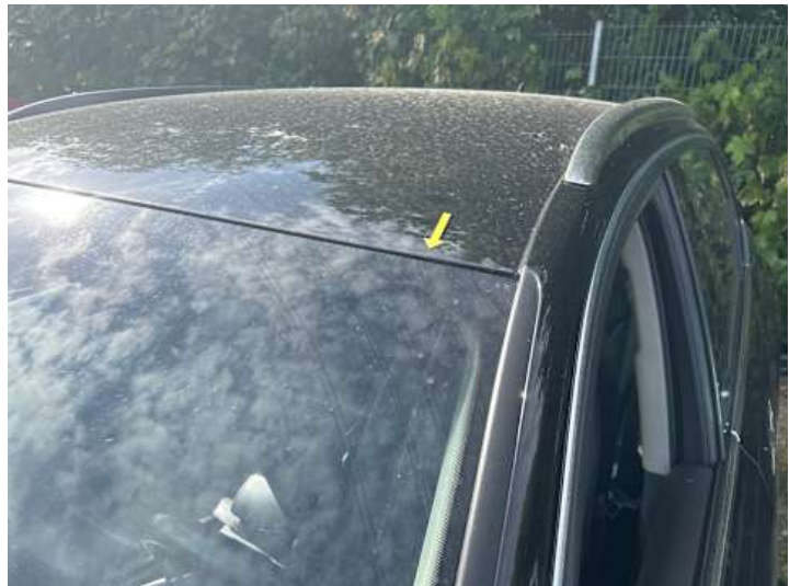
Dach (Lackschaden, Steinschlag)
