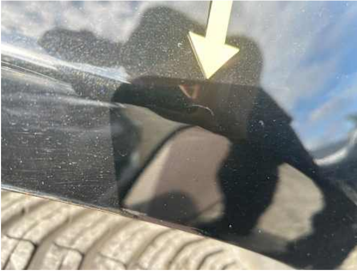
Kotflügel vorne rechts (Lackschaden)
