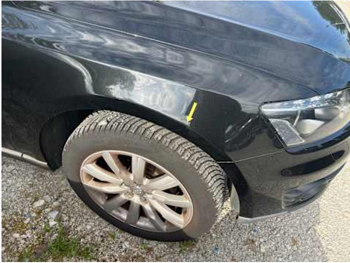
Kotflügel vorne rechts (Lackschaden)
