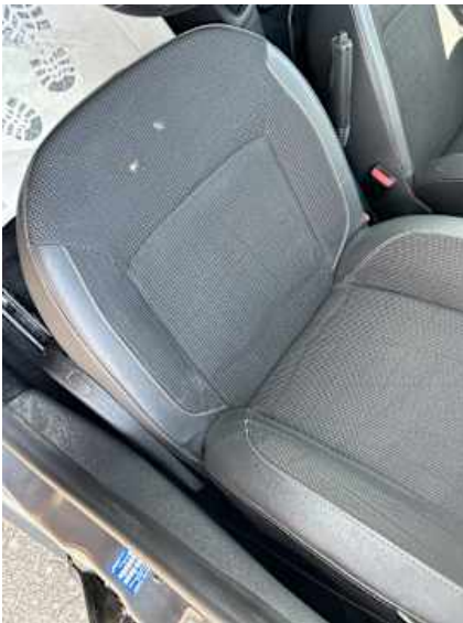
Innenraum (Verschmutzung, Verschleiß, Brandloch)
