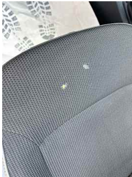
Innenraum (Verschmutzung, Verschleiß, Brandloch)
