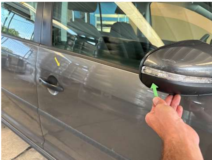
Beifahrertür (Delle, Riss/Bruch)
