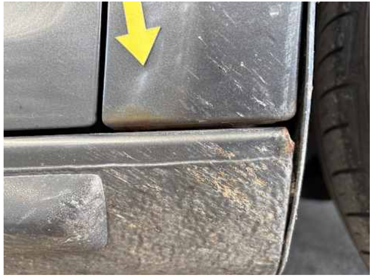
Kotflügel vorne rechts (Rost)
