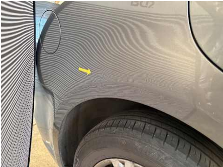
Seitenteil hinten rechts (Delle, Rost)
