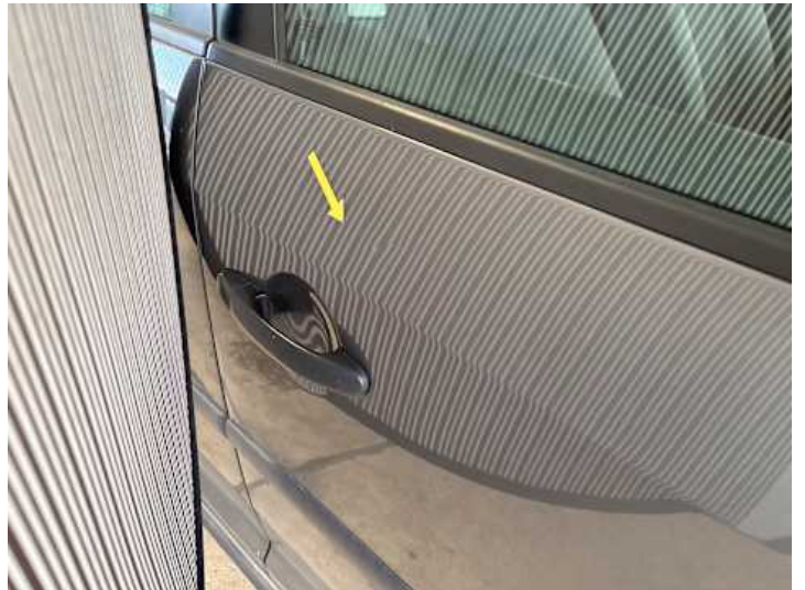
Beifahrertür (Delle, Riss/Bruch)
