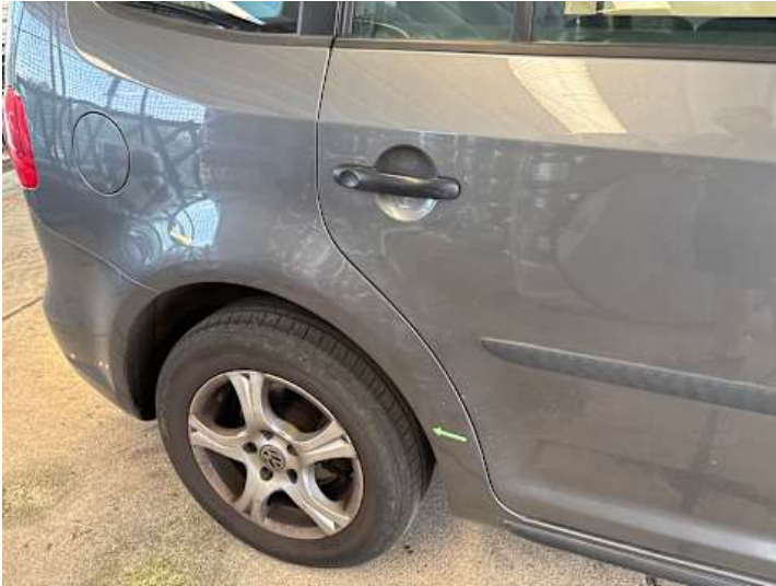
Seitenteil hinten rechts (Delle, Rost)
