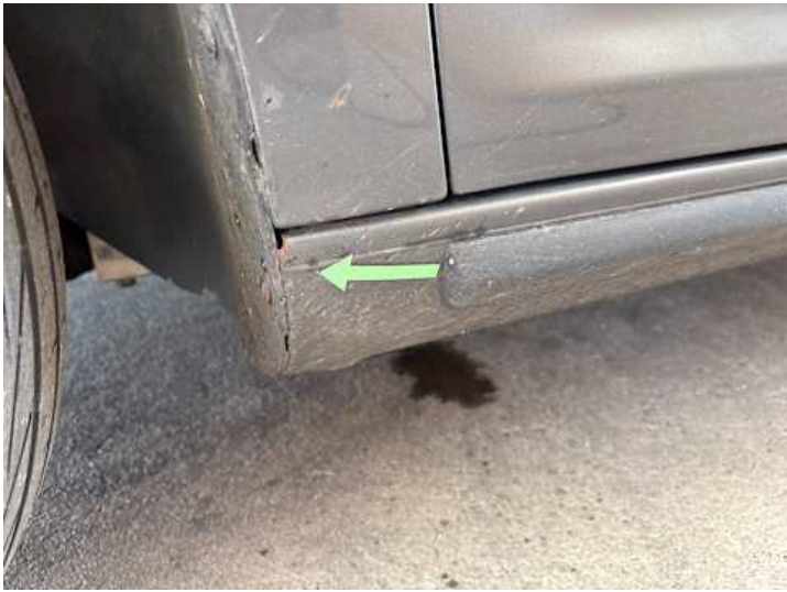
Schweller links (Rost)
