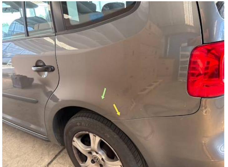
Seitenteil hinten links (Rost, Delle)
