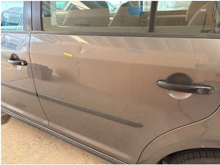
Türe hinten links (Delle, Lackschaden)
