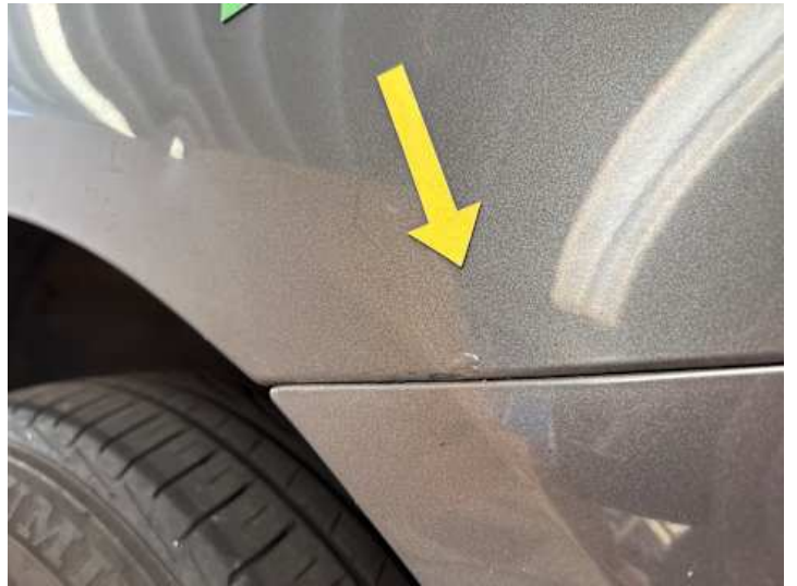
Seitenteil hinten links (Rost, Delle)
