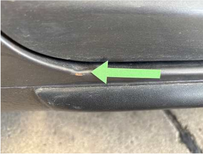
Schweller rechts (Delle, Rost)
