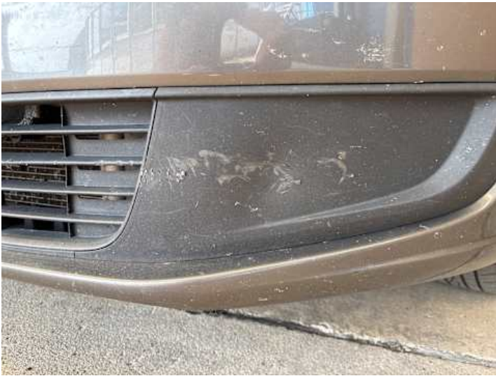
Stoßstange vorne (Kratzer, Delle)
