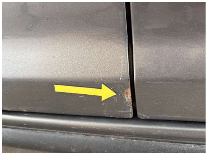
Fahrtür (Delle, Rost)
