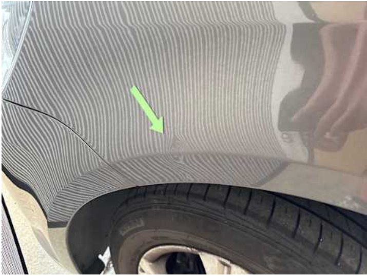
Kotflügel vorne links (Delle)
