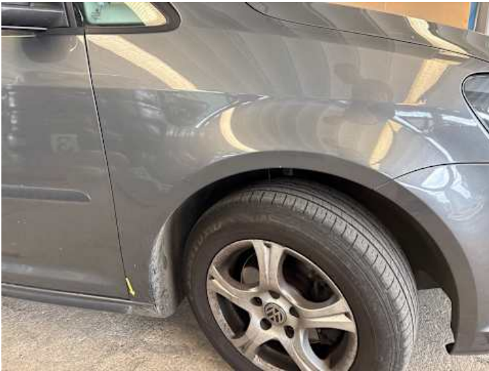
Kotflügel vorne rechts (Rost)
