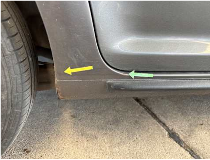
Schweller rechts (Delle, Rost)
