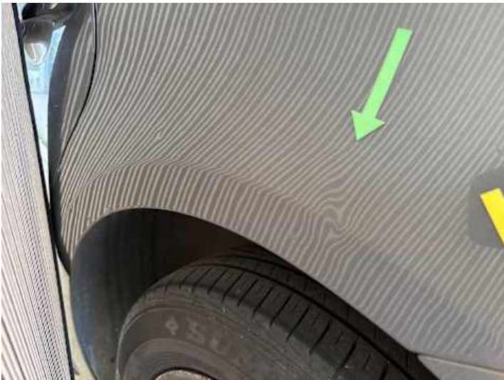
Seitenteil hinten links (Rost, Delle)
