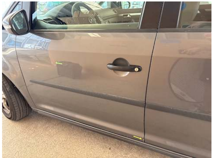
Fahrertür (Delle, Rost)
