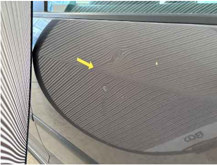
Türe hinten links (Delle, Lackschaden)
