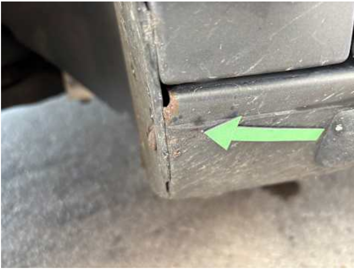
Schweller links (Rost)
