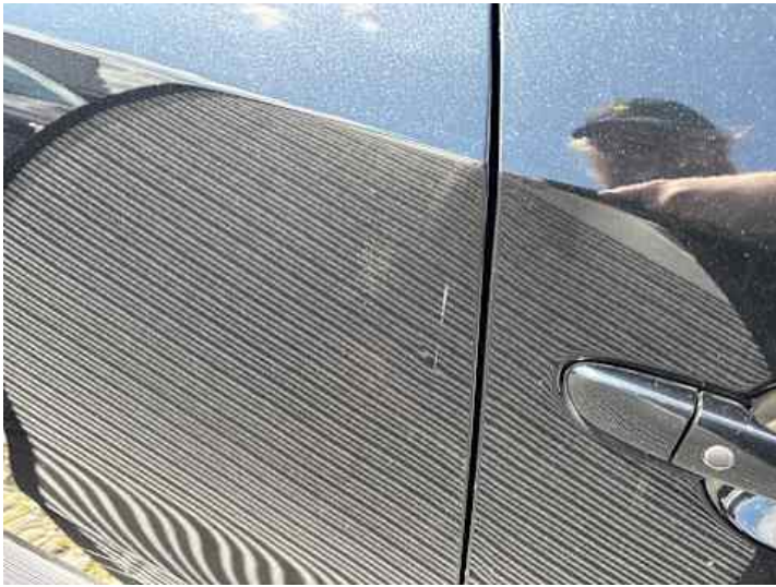
Türe hinten rechts (Verformung)
