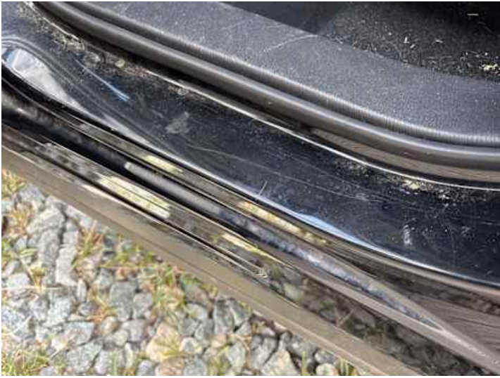
Schweller links (Kratzer)
