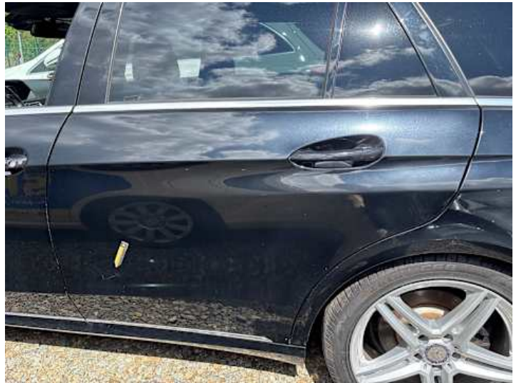
Türe hinten links (Kratzer)
