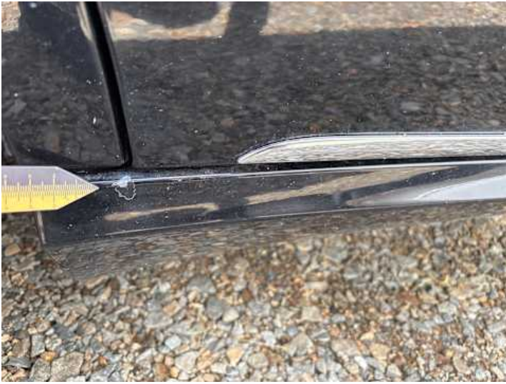
Schweller rechts (Lackschaden)
