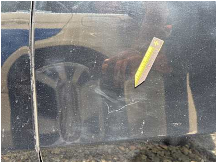
Türe hinten links (Kratzer)
