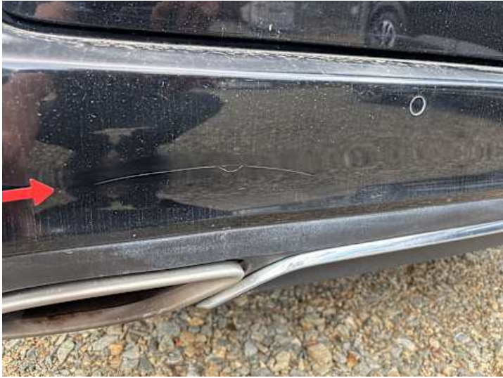
Stoßstange hinten (Kratzer, Unsachgemäß instand gesetzt)
