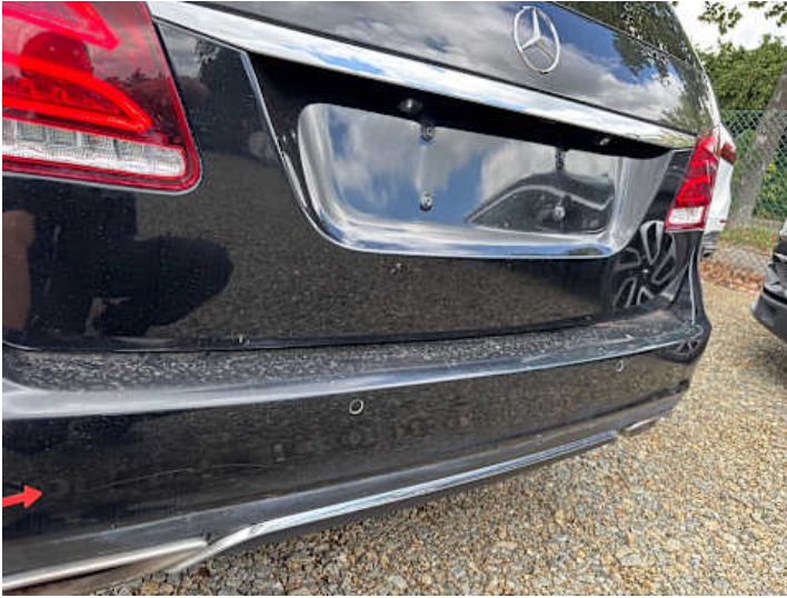
Stoßstange hinten (Kratzer, Unsachgemäß instand gesetzt)
