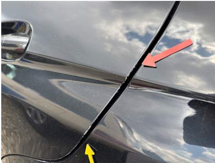
Türe hinten links (Kratzer)
