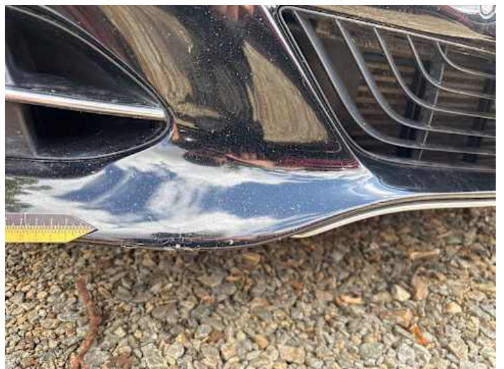
Stoßstange vorne (Lackschaden, Riss/Bruch)
