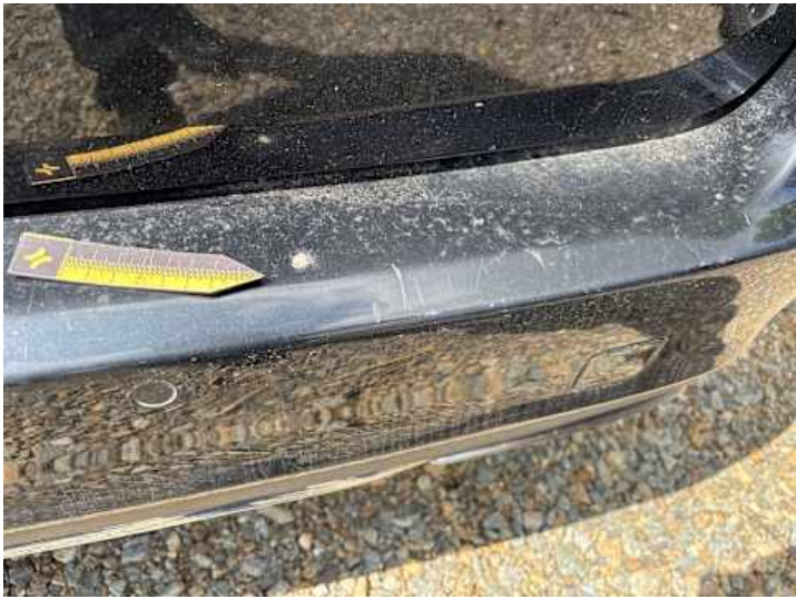
Stoßstange hinten (Kratzer)
