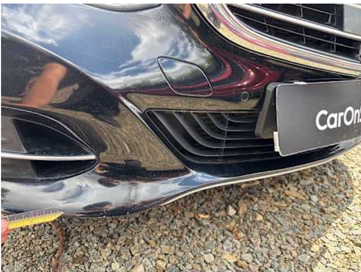
Stoßstange vorne (Lackschaden, Riss/Bruch)
