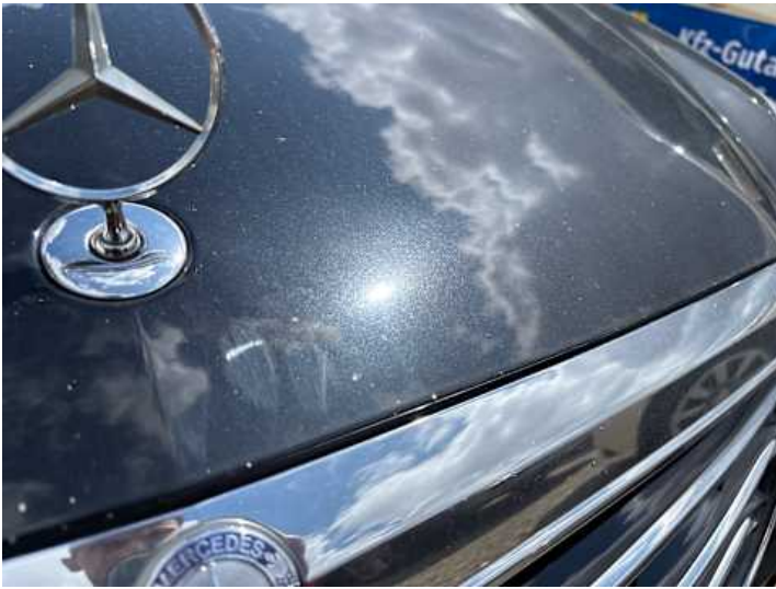
Motorhaube (Anderer Schaden): Mehrere Steinschläge auf der Oberfläche
