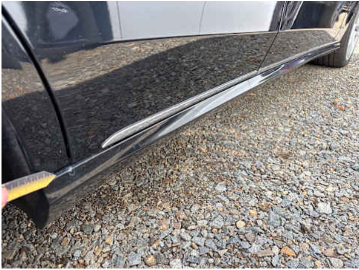
Schweller rechts (Lackschaden)
