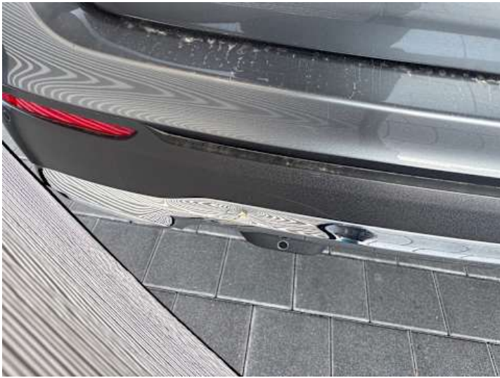
Stoßstange hinten (Riss/Bruch, Verformung)
