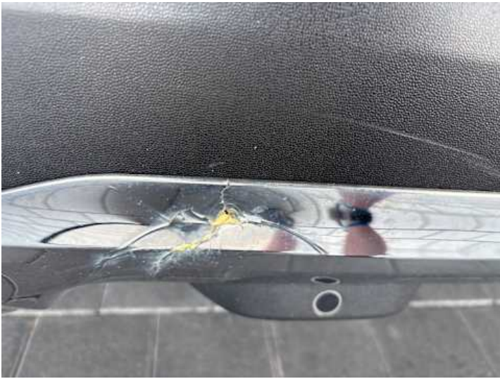
Stoßstange hinten (Riss/Bruch, Verformung)
