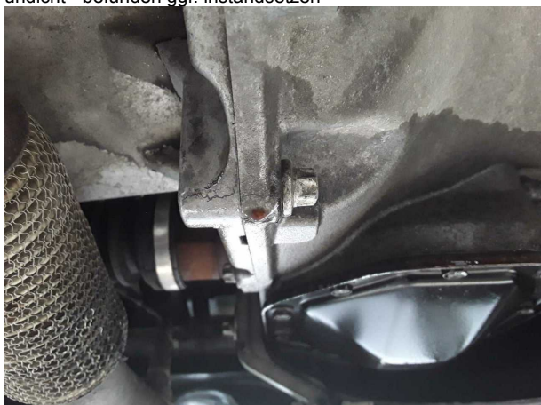
Beschädigung #1: Getriebe: Getriebe (Folgekosten möglich) - undicht - befunden ggf. instandsetzen
