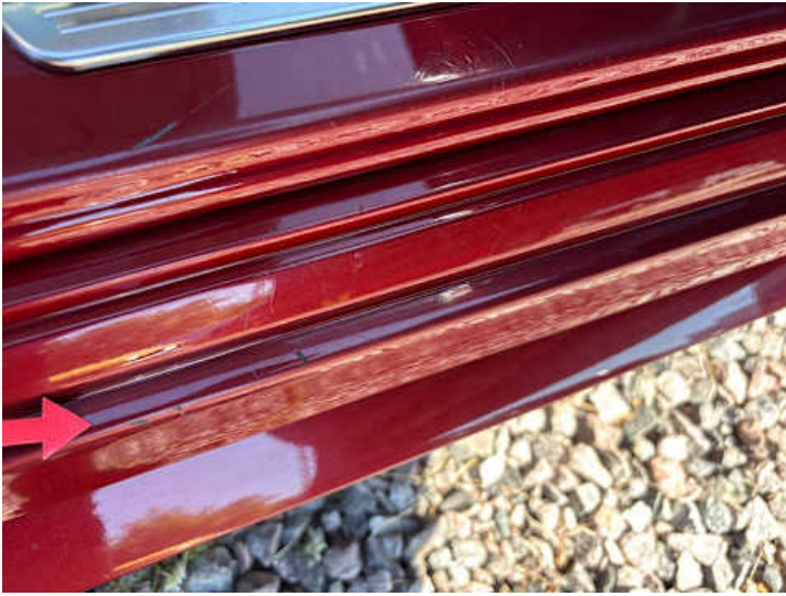
Schweller rechts (Lackschaden)
