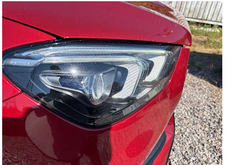
Scheinwerfer (rechts) (Steinschlag)
