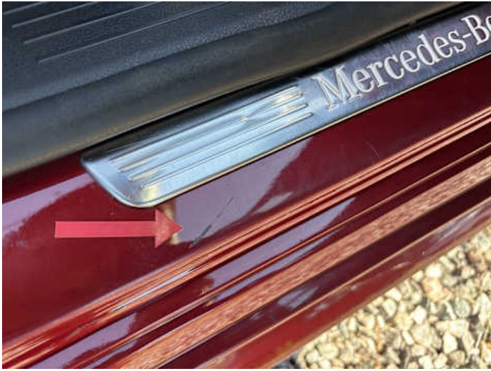
Schweller rechts (Lackschaden)
