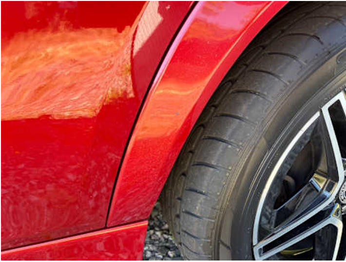
Seitenteil hinten links (Lackschaden, Steinschlag)
