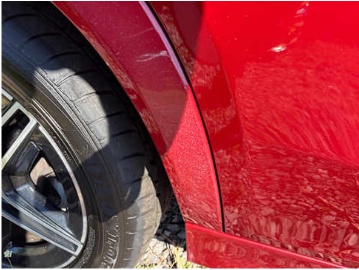
Seitenteil hinten rechts (Steinschlag)
