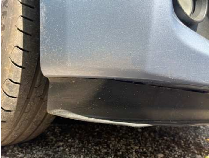
Stoßstange vorne (Kratzer, Lackschaden)
