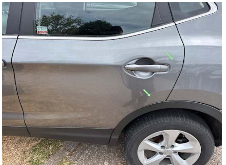
Türe hinten links (Lackschaden, Delle)
