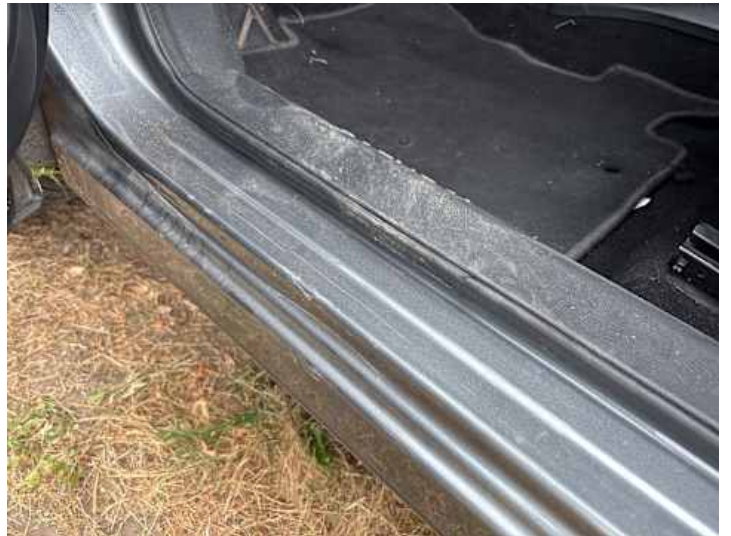
Schweller links (Kratzer)
