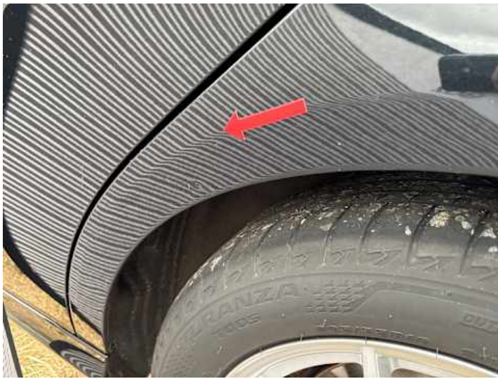
Seitenteil hinten links (Delle)
