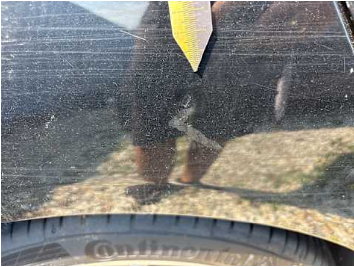
Seitenteil hinten rechts (Unsachgemäß instand gesetzt)
