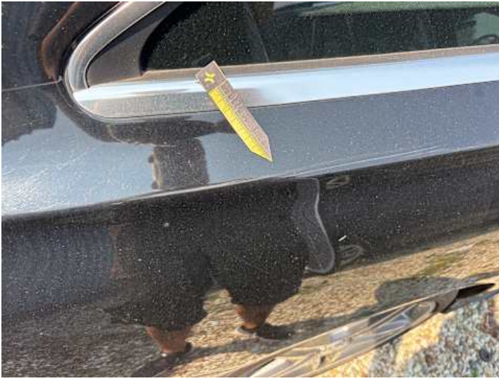
Seitenteil hinten rechts (Kratzer)
