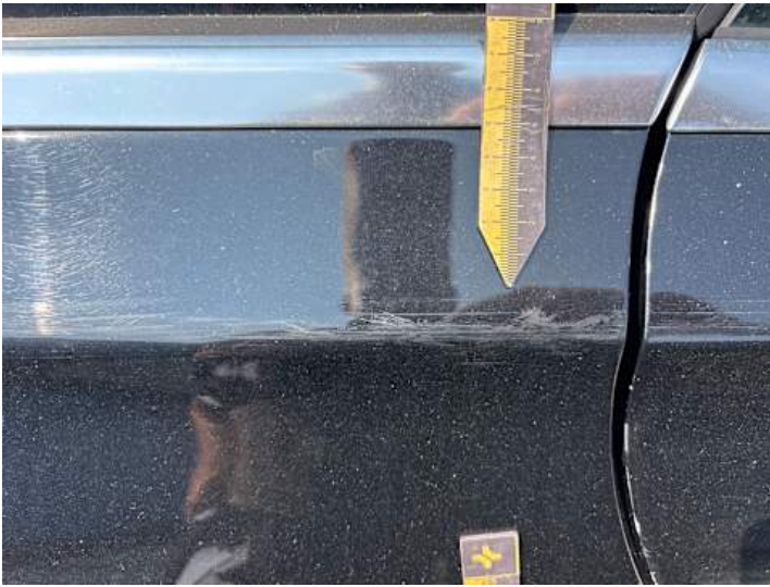
Seitenteil hinten rechts (Unsachgemäß instand gesetzt)
