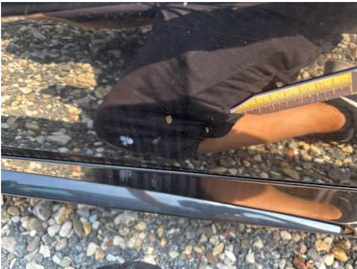
Türe hinten links (Unsachgemäß instand gesetzt)
