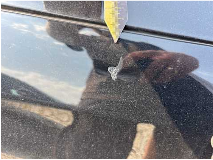
Kotflügel vorne rechts (Unsachgemäß instand gesetzt)
