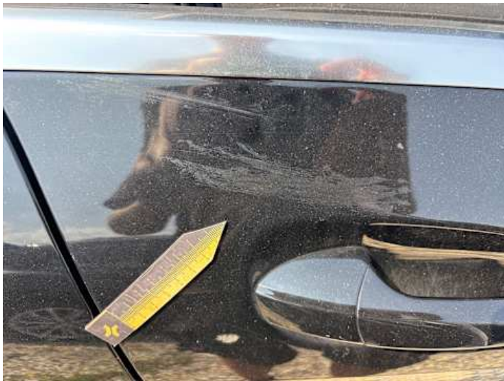
Beifahrtür (Unsachgemäß instand gesetzt)
