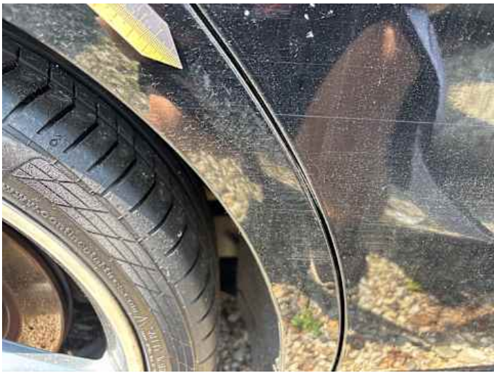
Seitenteil hinten rechts (Unsachgemäß instand gesetzt)
