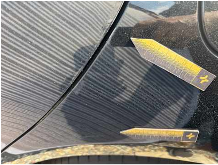
Seitenteil hinten links (Kratzer, Delle, Unsachgemäß instand gesetzt)
