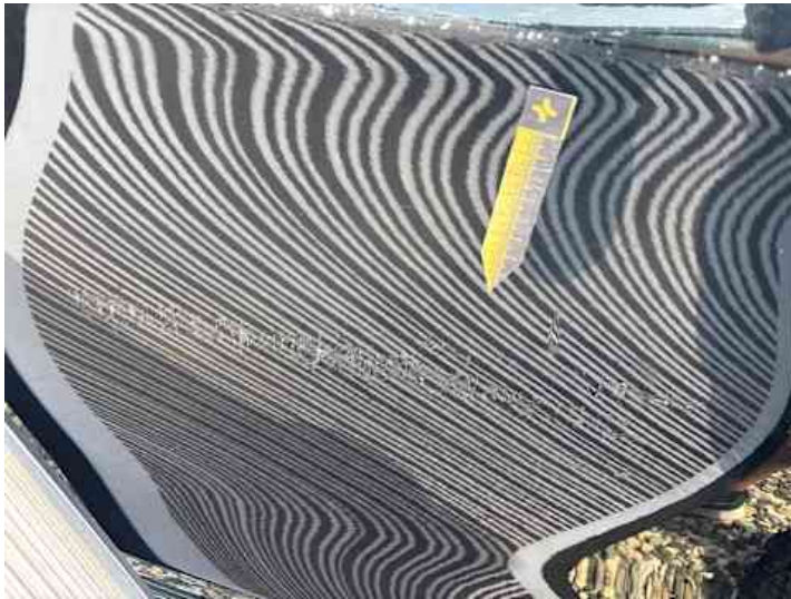
Fahrtür (Lackschaden, Unsachgemäß instand gesetzt, Kratzer)
