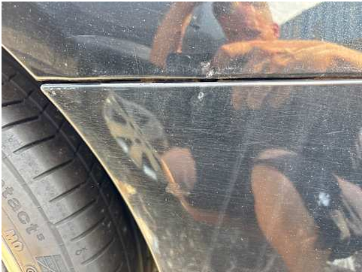
Stoßstange hinten (Unsachgemäß instand gesetzt, Kratzer)
