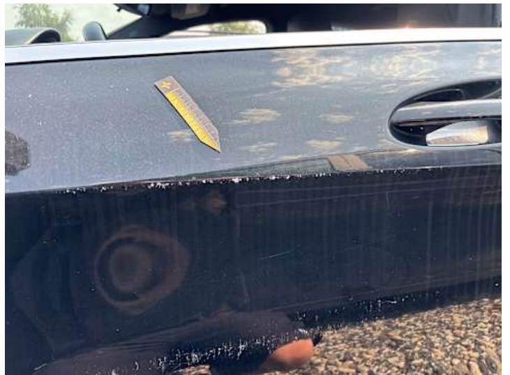
Fahrtür (Lackschaden, Unsachgemäß instand gesetzt, Kratzer)
