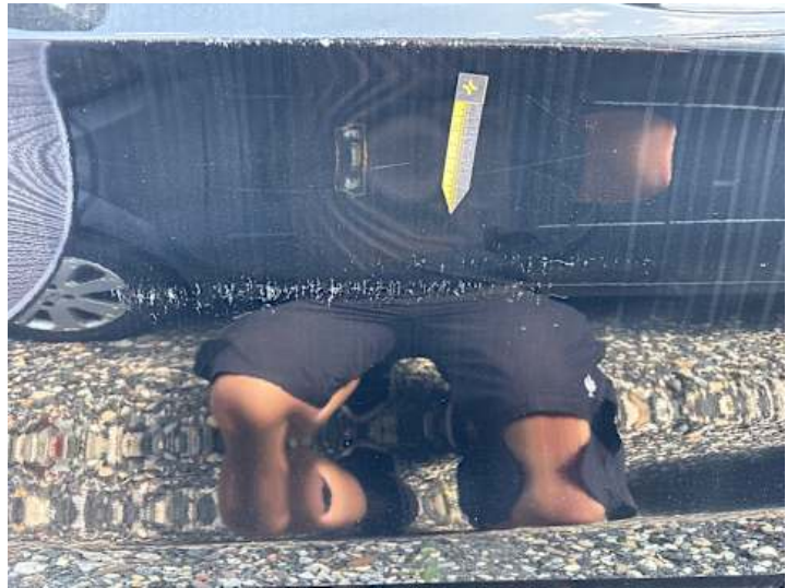
Fahrtür (Lackschaden, Unsachgemäß instand gesetzt, Kratzer)
