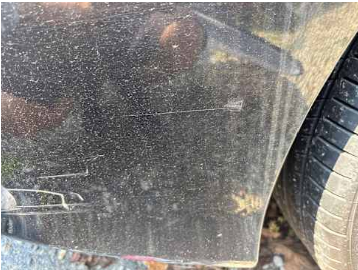
Stoßstange hinten (Unsachgemäß instand gesetzt, Kratzer)
