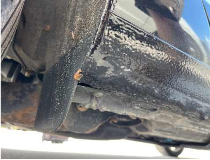
Schweller rechts (Rost, Lackschaden, Unsachgemäß instand gesetzt)
