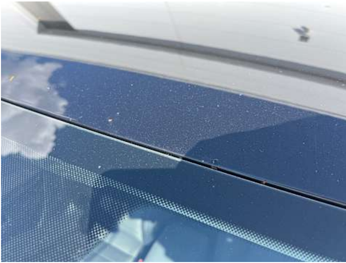
Dach (Kratzer, Lackschaden, Unsachgemäß instand gesetzt, Rost)
