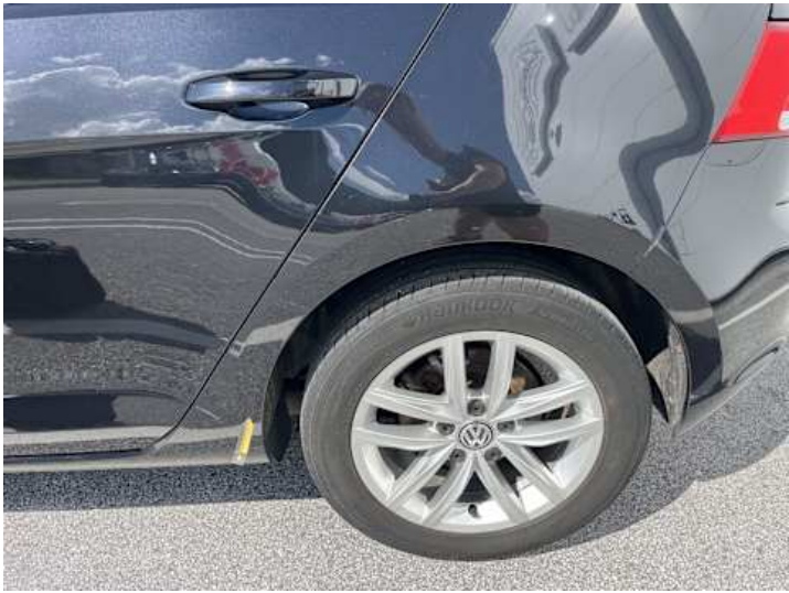
Seitenteil hinten links (Lackschaden, Rost)
