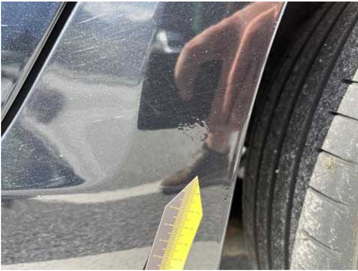
Seitenteil hinten links (Lackschaden, Rost)
