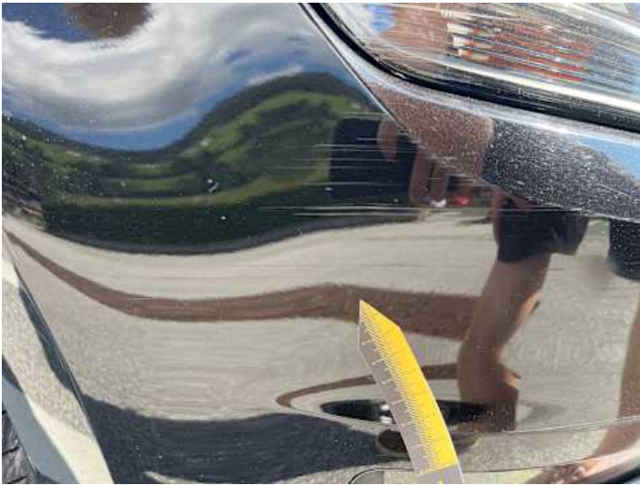
Stoßstange vorne (Kratzer, Lackschaden)
