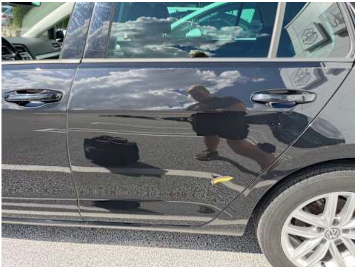
Türe hinten links (Lackschaden, Unsachgemäß instand gesetzt)
