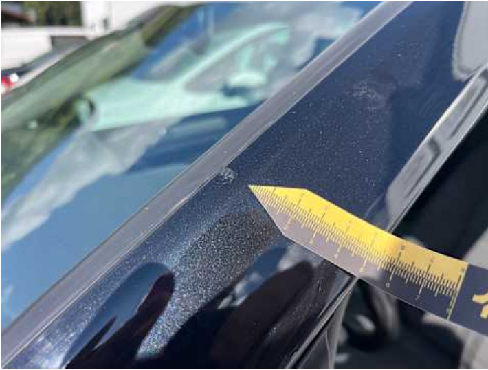
Seitenteil hinten links (Lackschaden, Rost)
