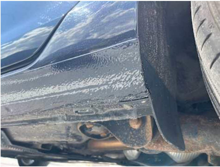
Schweller links (Rost, Lackschaden)
