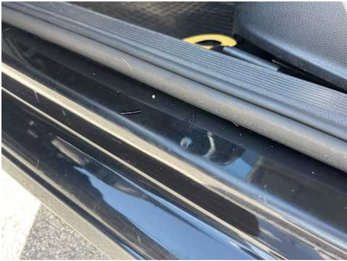
Schweller links (Rost, Lackschaden, Delle)
