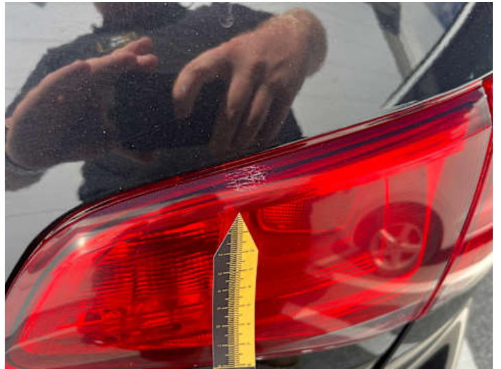
Rücklicht (rechts) (Riss/Bruch)
