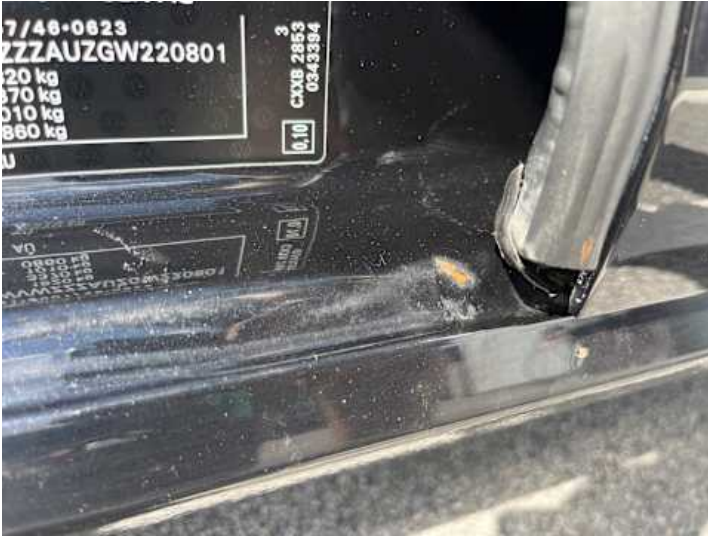
Schweller links (Rost, Lackschaden, Delle)
