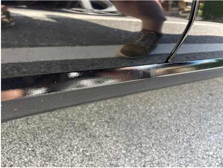
Schweller rechts (Rost, Lackschaden, Unsachgemäß instand gesetzt)
