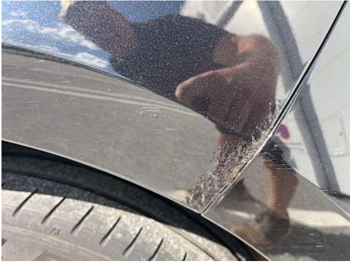
Seitenteil hinten links (Lackschaden, Rost)
