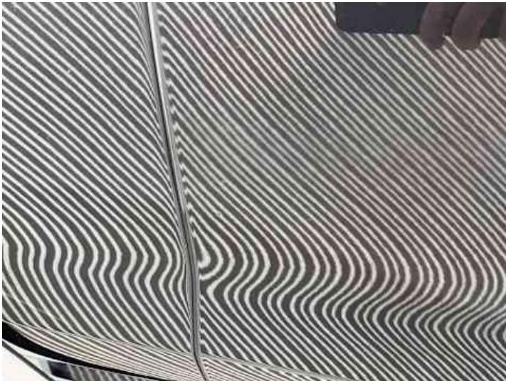
Türe hinten links (Lackschaden, Unsachgemäß instand gesetzt)
