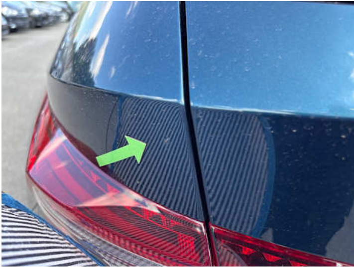
Seitenteil hinten links (Kratzer, Delle)
