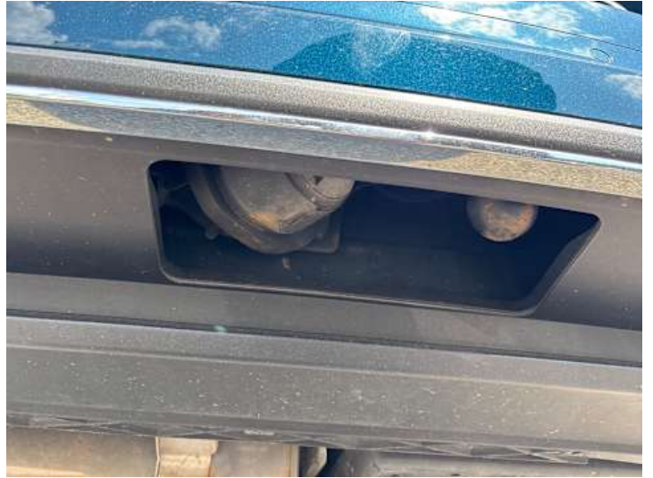
Innenraum (Anderer Schaden): Anhängerkupplung klappt nicht aus
