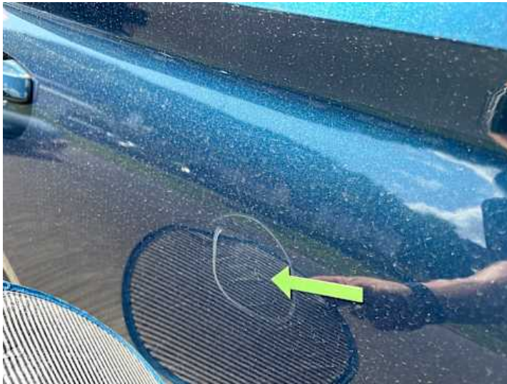
Türe hinten rechts (Kratzer, Delle)
