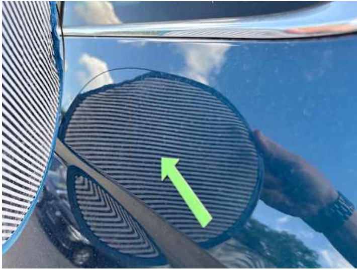
Seitenteil hinten links (Kratzer, Delle)
