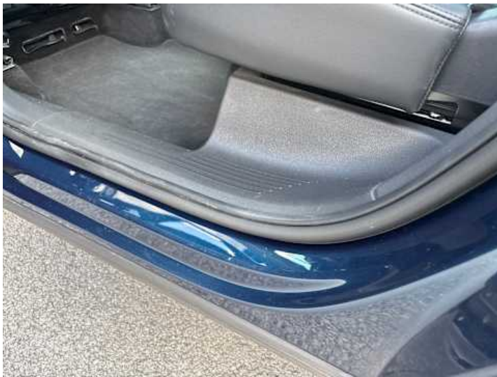
Türe hinten links (Kratzer, Delle)
