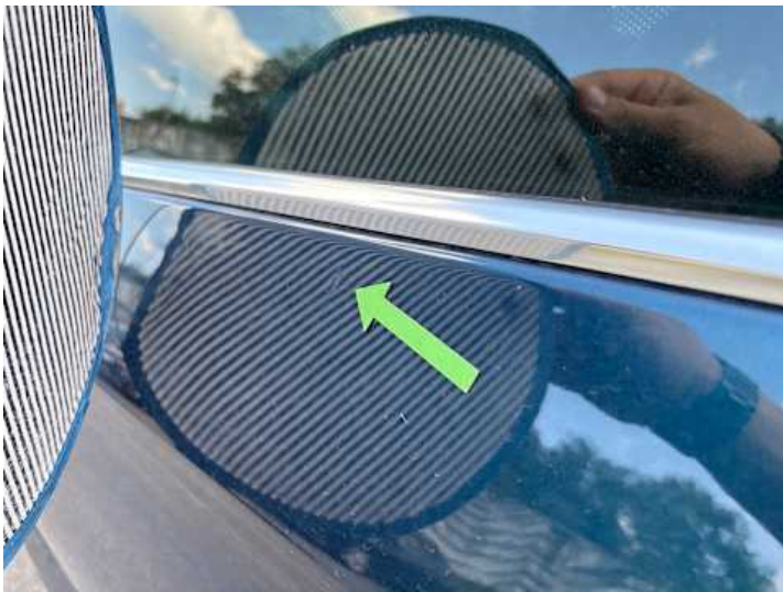
Türe hinten links (Kratzer, Delle)
