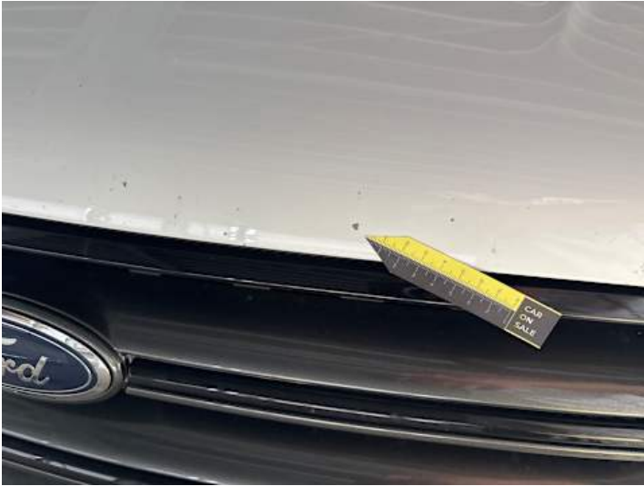
Motorhaube (Steinschlag, Lackschaden)
