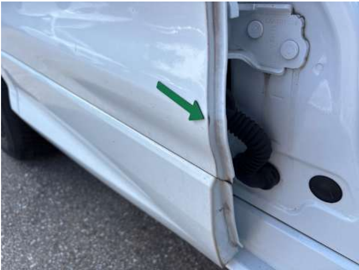
Türe hinten rechts (Lackschaden)
