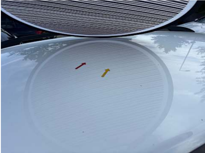
Dach (Delle, Steinschlag)
