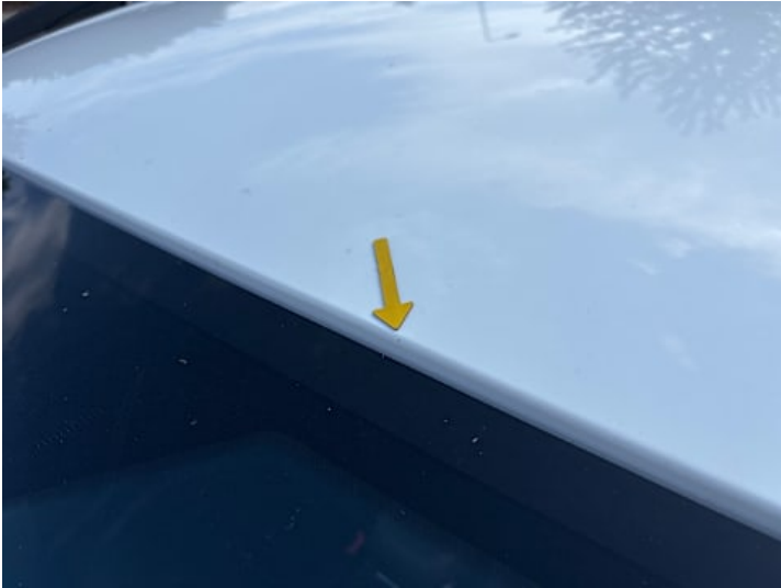
Dach (Delle, Steinschlag)
