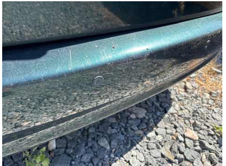
Stoßstange hinten (Lackschaden, Kratzer, Anderer Schaden): Sensor von Einparkhilfe fehlt,
