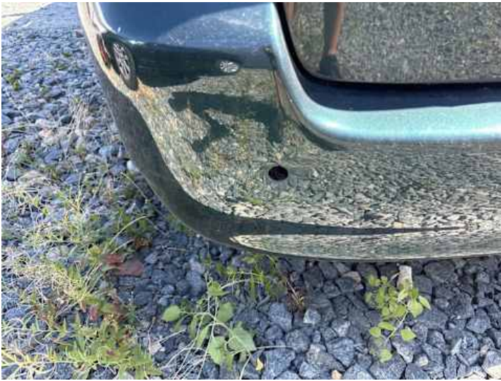
Stoßstange hinten (Lackschaden, Kratzer, Anderer Schaden): Sensor von Einparkhilfe fehlt,
