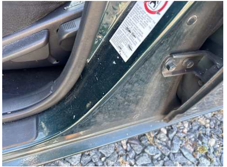
Schweller links (Lackschaden, Delle)
