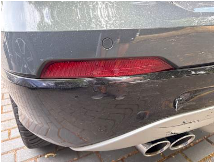
Stoßstange hinten (Kratzer, Riss/Bruch)
