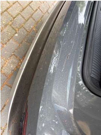
Stoßstange hinten (Kratzer, Riss/Bruch)
