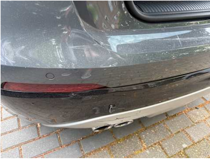
Stoßstange hinten (Kratzer, Riss/Bruch)
