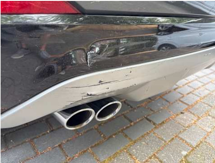
Stoßstange hinten (Kratzer, Riss/Bruch)
