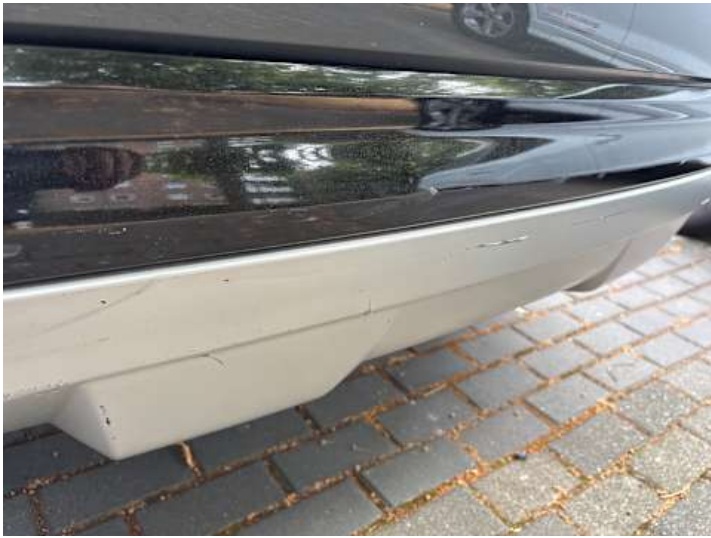
Stoßstange hinten (Kratzer, Riss/Bruch)
