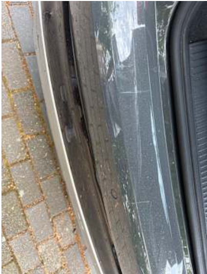
Stoßstange hinten (Kratzer, Riss/Bruch)
