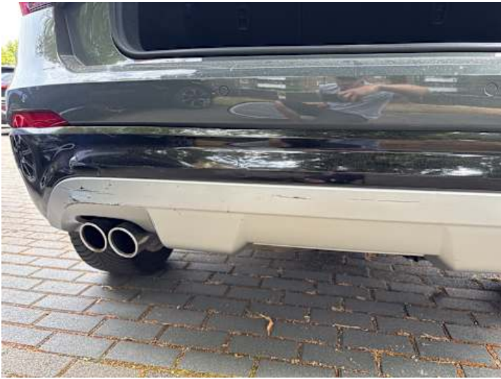
Stoßstange hinten (Kratzer, Riss/Bruch)
