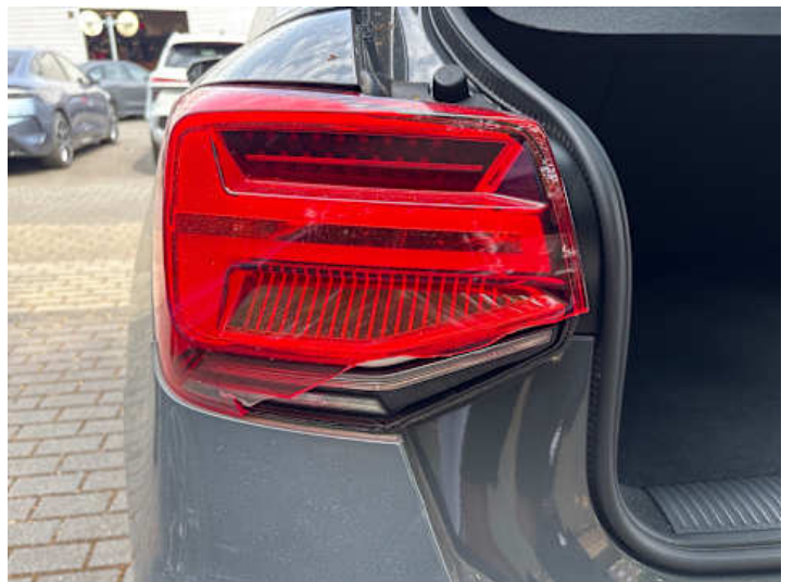
Rücklicht (links) (Riss/Bruch)
