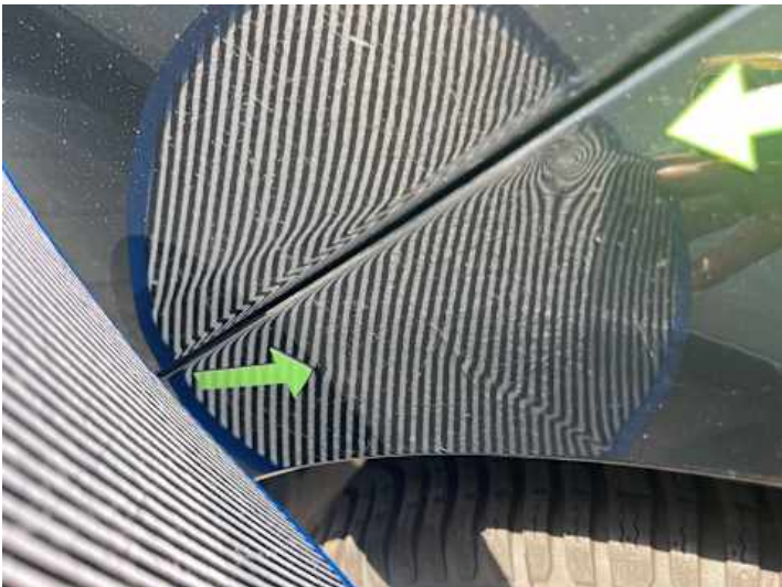
Seitenteil hinten links (Lackschaden, Delle)
