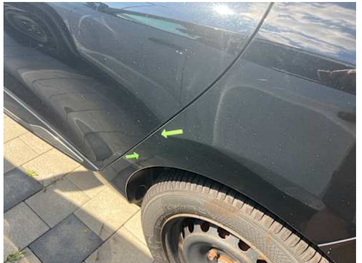
Seitenteil hinten links (Lackschaden, Delle)
