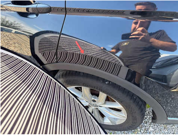
Seitenteil hinten links (Lackschaden, Delle, Unsachgemäß instand gesetzt)
