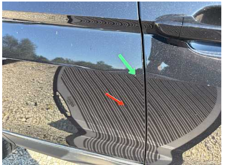
Türe hinten rechts (Kratzer, Lackschaden, Delle)
