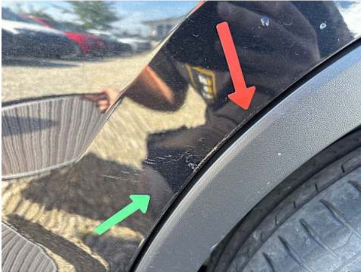
Türe hinten links (Kratzer, Lackschaden, Unsachgemäß instand gesetzt, Delle)
