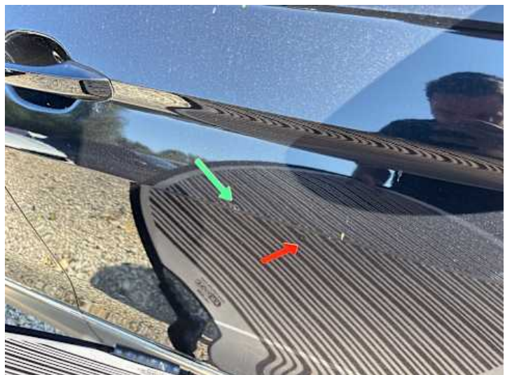
Beifahrertür (Kratzer, Delle, Lackschaden)
