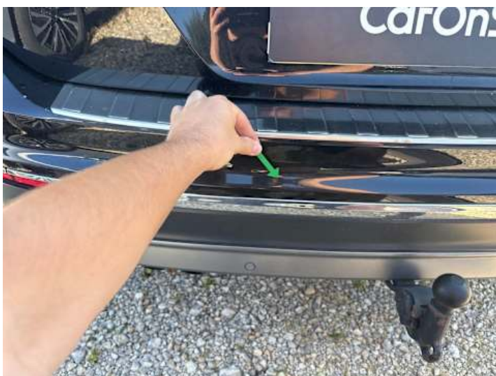
Stoßstange hinten (Kratzer, Lackschaden, Unsachgemäß instand gesetzt)
