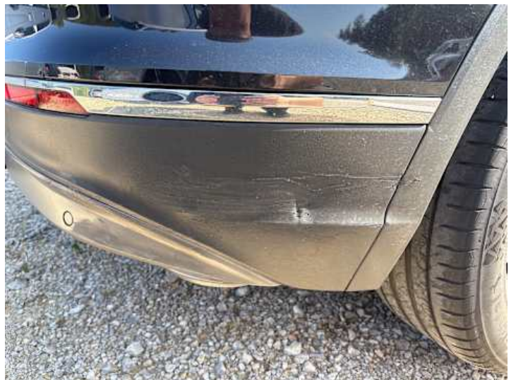
Stoßstange hinten (Verformung, Riss/Bruch, Kratzer, Lackschaden)
