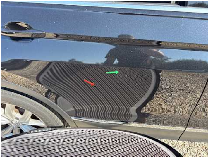
Türe hinten rechts (Kratzer, Lackschaden, Delle)
