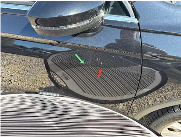
Beifahrertür (Kratzer, Delle, Lackschaden)
