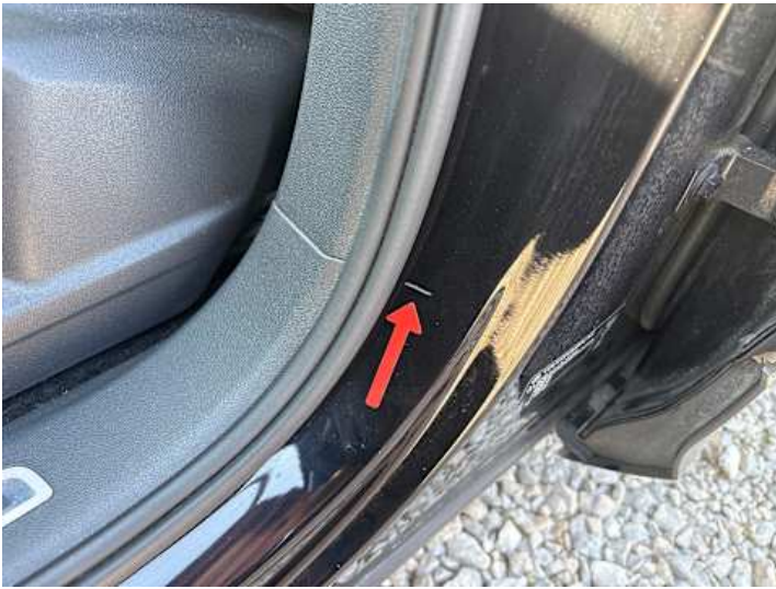
Schweller links (Lackschaden, Kratzer)
