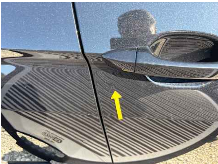
Beifahrertür (Kratzer, Delle, Lackschaden)
