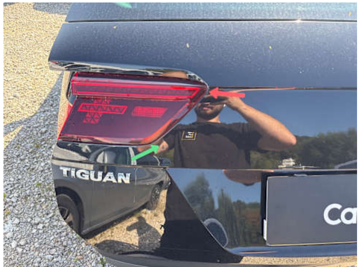
Heckklappe (Lackschaden, Rost, Unsachgemäß instand gesetzt)
