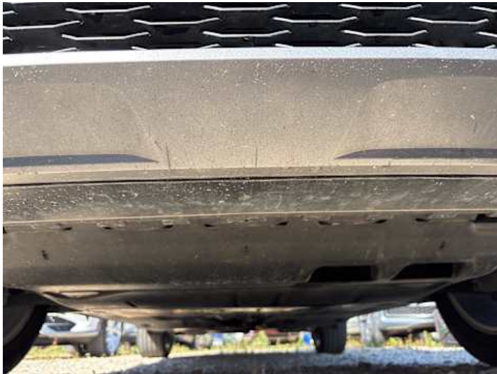
Stoßstange vorne (Kratzer, Lackschaden)
