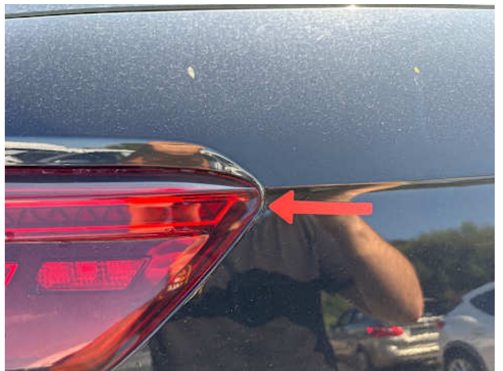
Heckklappe (Lackschaden, Rost, Unsachgemäß instand gesetzt)
