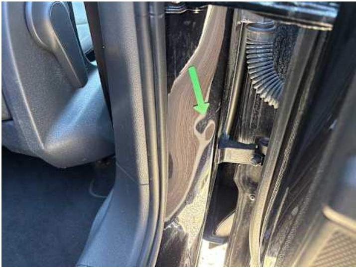
Schweller rechts (Delle, Kratzer, Lackschaden)
