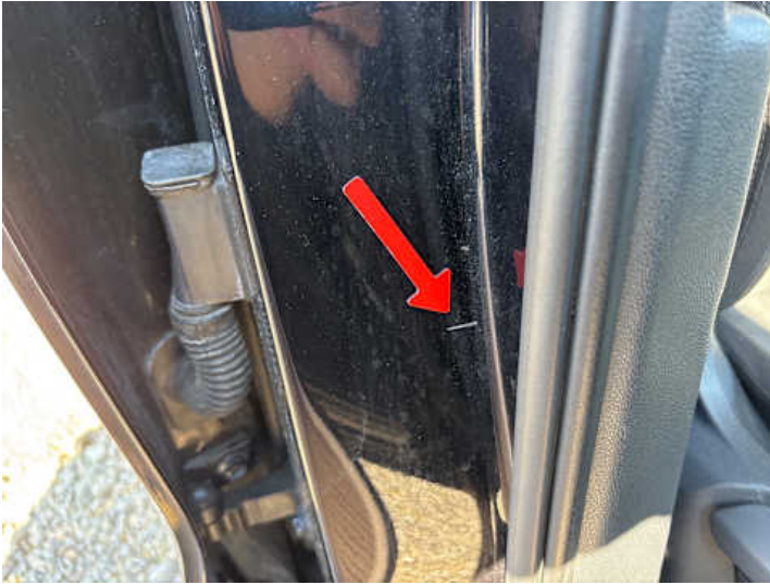
Schweller rechts (Delle, Kratzer, Lackschaden)
