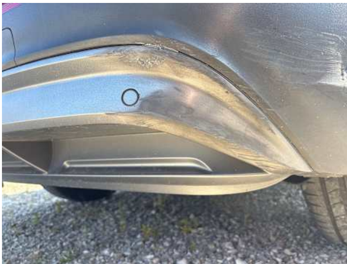
Stoßstange hinten (Verformung, Riss/Bruch, Kratzer, Lackschaden)
