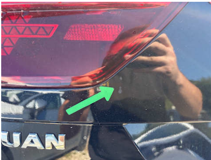
Heckklappe (Lackschaden, Rost, Unsachgemäß instand gesetzt)
