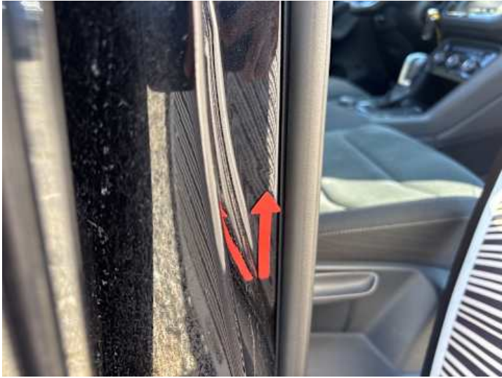
Schweller rechts (Delle, Kratzer, Lackschaden)
