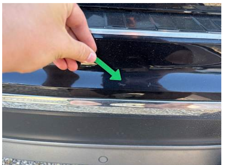
Stoßstange hinten (Kratzer, Lackschaden, Unsachgemäß instand gesetzt)
