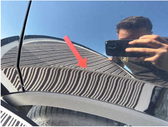
Seitenteil hinten links (Lackschaden, Delle, Unsachgemäß instand gesetzt)
