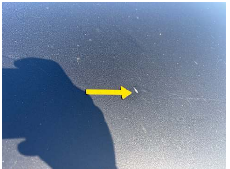
Motorhaube (Steinschlag, Kratzer, Lackschaden)
