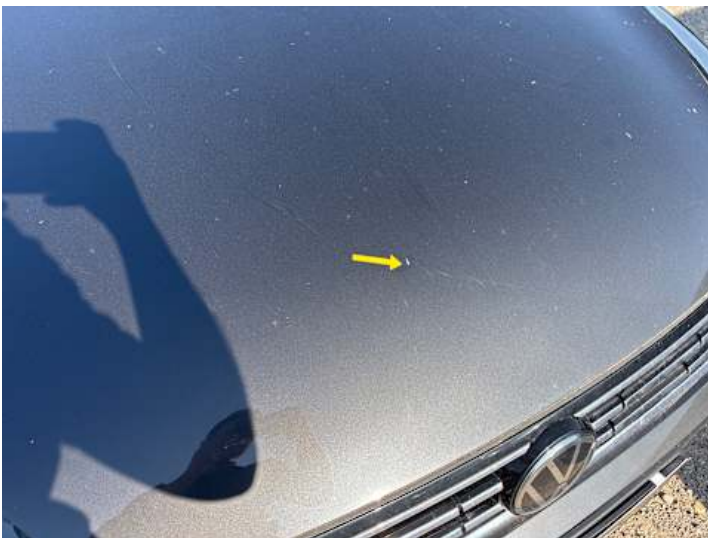
Motorhaube (Steinschlag, Kratzer, Lackschaden)
