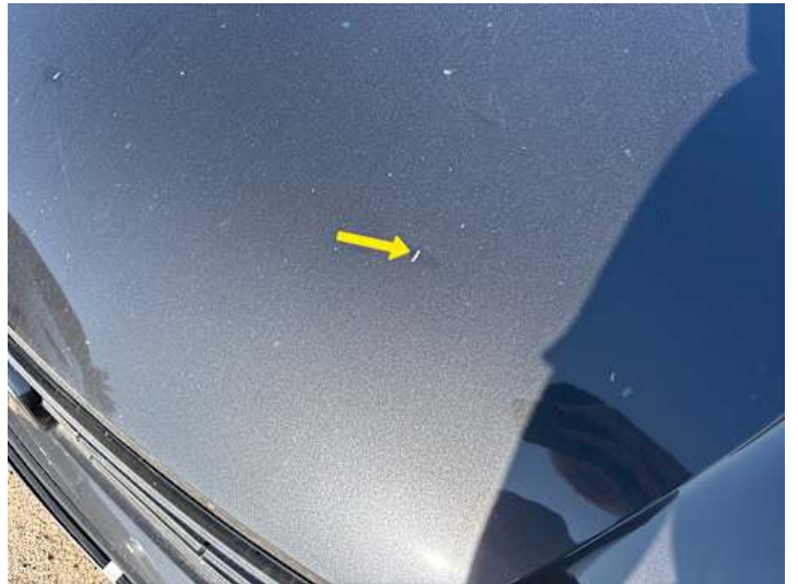
Motorhaube (Steinschlag, Kratzer, Lackschaden)
