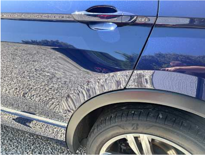
Türe hinten links (Delle)
