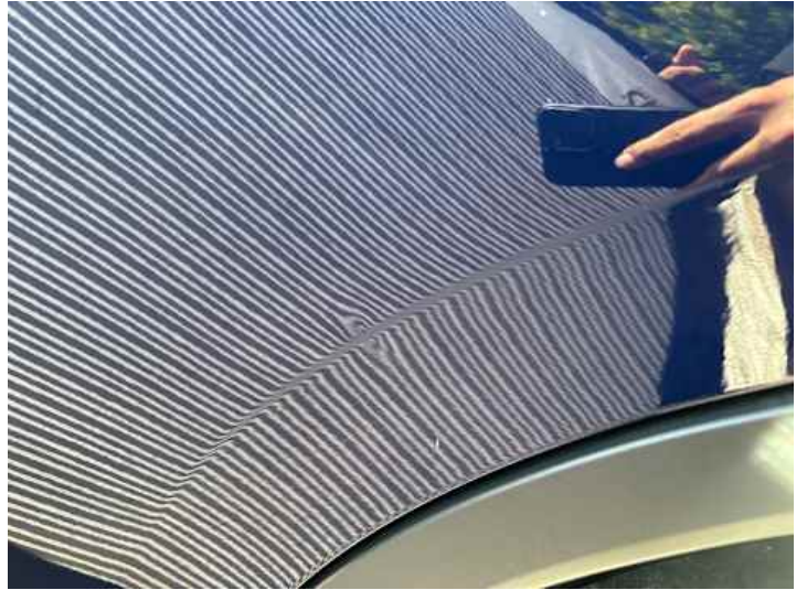
Türe hinten links (Delle)
