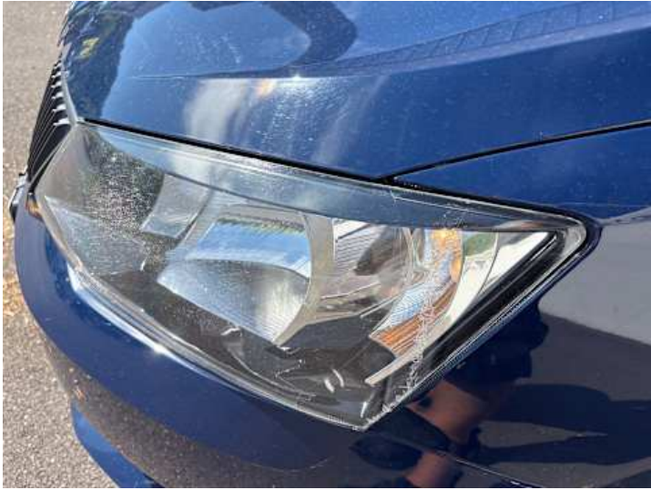
Scheinwerfer (links) (Riss/Bruch, Blind)
