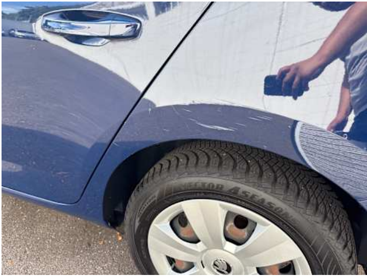
Seitenteil hinten links (Verformung, Lackschaden)
