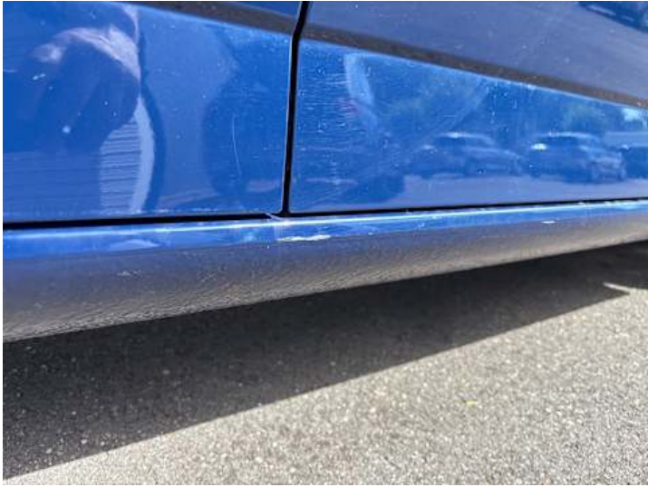
Schweller rechts (Lackschaden)
