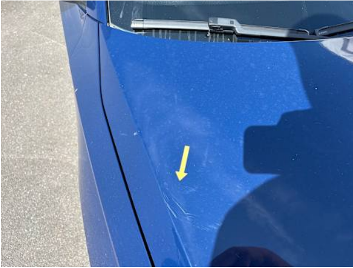
Motorhaube (Lackschaden, Kratzer)
