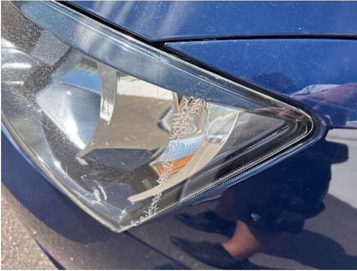
Scheinwerfer (links) (Riss/Bruch, Blind)
