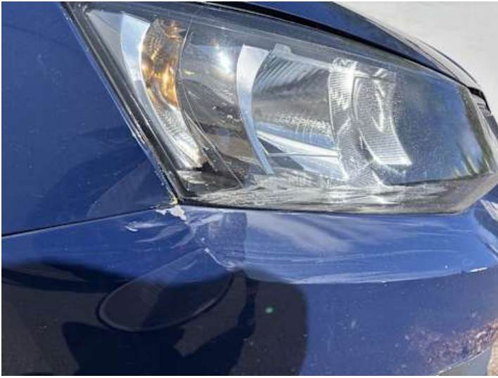
Scheinwerfer (rechts) (Riss/Bruch, Kratzer)
