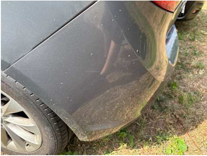
Stoßstange hinten (Kratzer)
