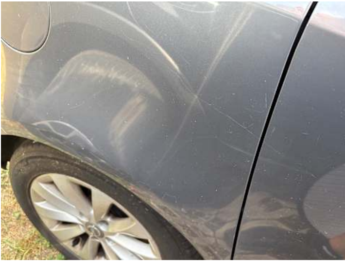
Seitenteil hinten rechts (Kratzer)
