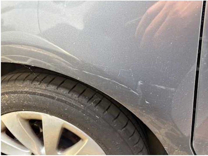
Seitenteil hinten rechts (Kratzer)
