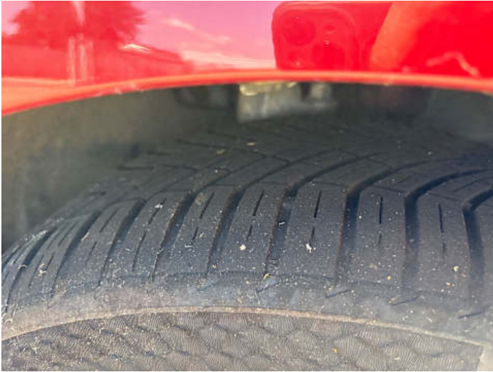
Rad (Ungleichmäßig abgefahren)
