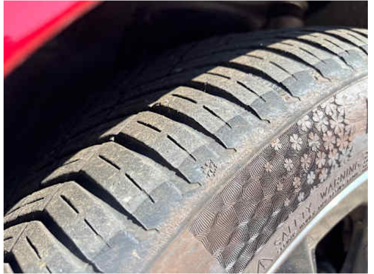
Rad (Ungleichmäßig abgefahren)
