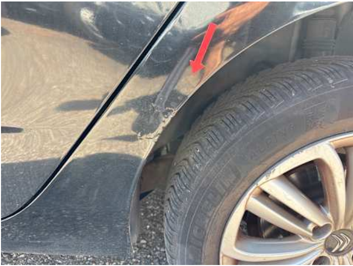
Seitenteil hinten links (Rost)
