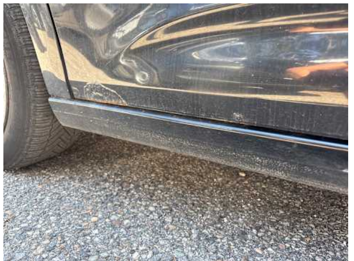
Fahrtür (Delle, Rost)
