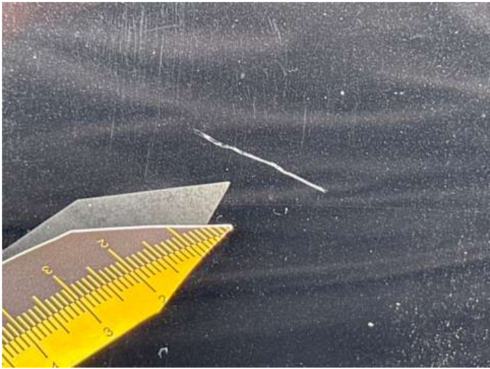
Kotflügel vorne links (Kratzer)
