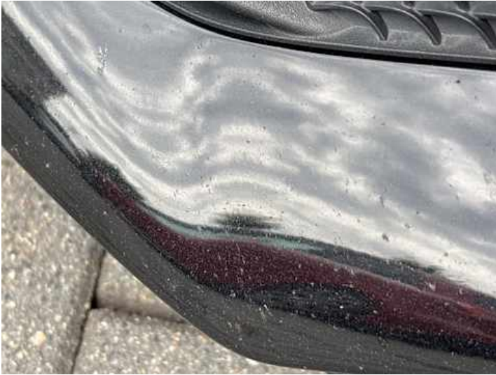
Stoßstange vorne (Steinschlag, Lackschaden)
