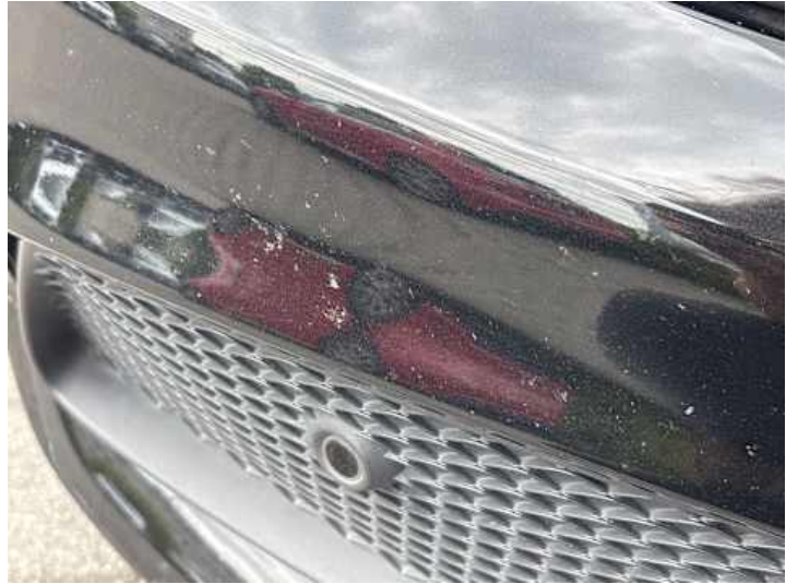
Stoßstange vorne (Steinschlag, Lackschaden)
