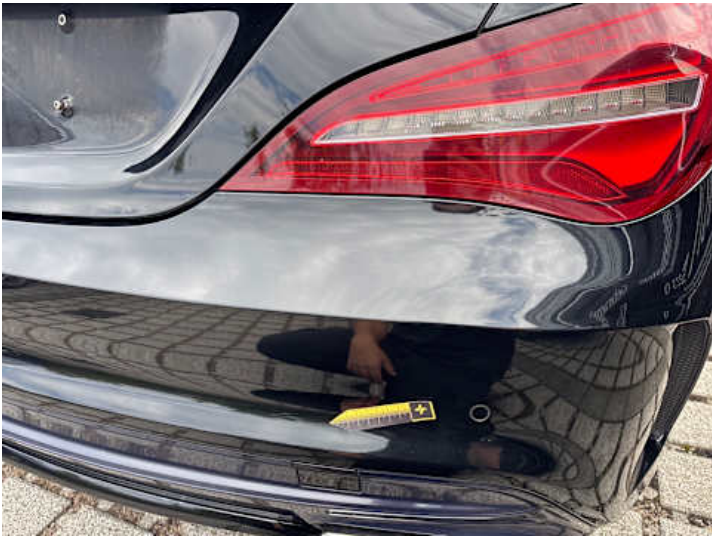
Stoßstange hinten (Kratzer, Lackschaden)
