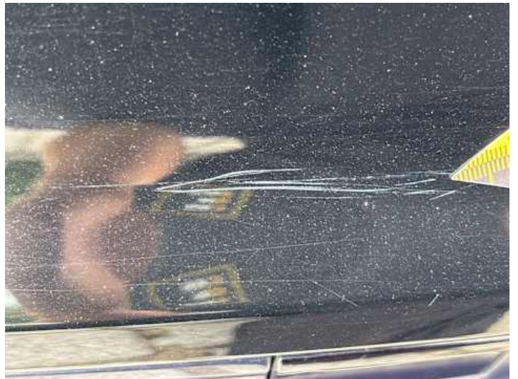
Stoßstange hinten (Kratzer, Lackschaden)
