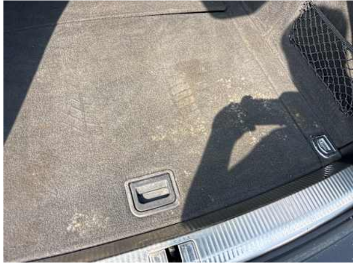
Innenraum (Anderer Schaden): Schimmel
