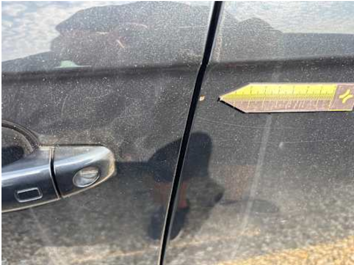
Türe hinten links (Steinschlag)
