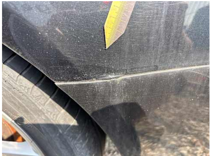
Seitenteil hinten links (Lackschaden, Rost)
