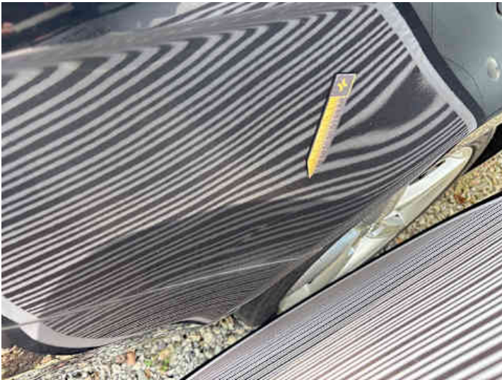
Seitenteil hinten rechts (Verformung)
