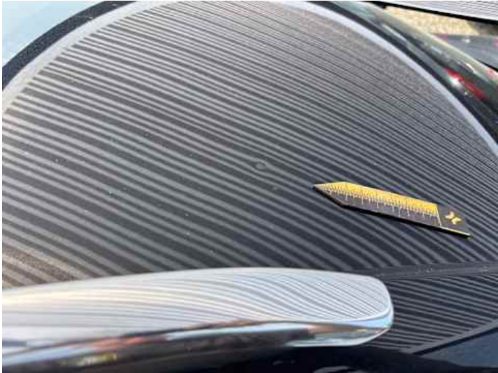
Dach (Delle, Steinschlag)
