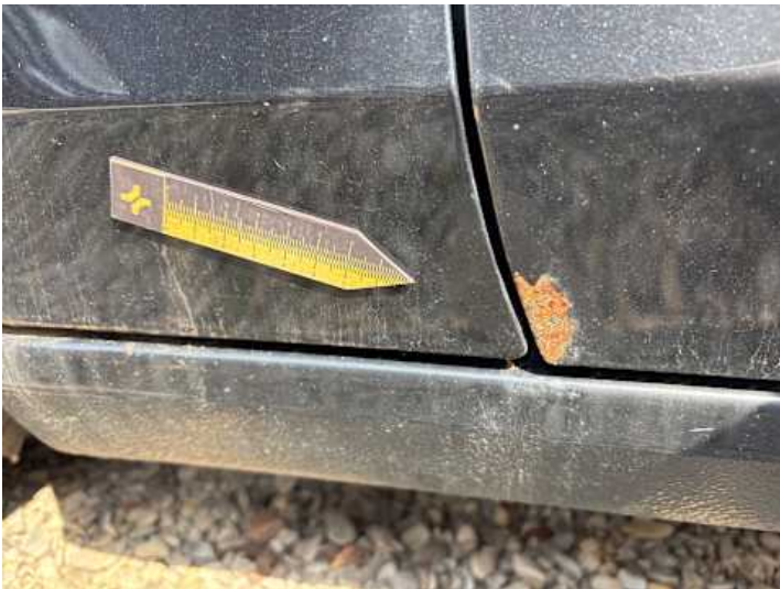
Kotflügel vorne links (Unsachgemäß instand gesetzt)
