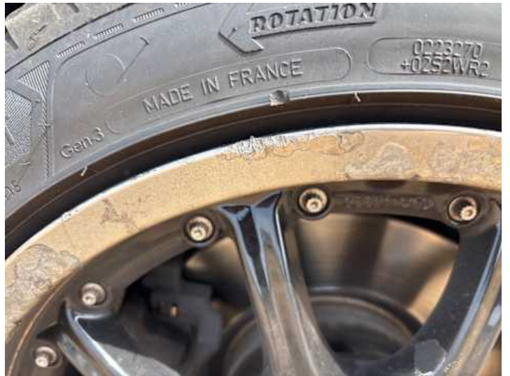
Rad (Kratzer, Kerben, Rost)
