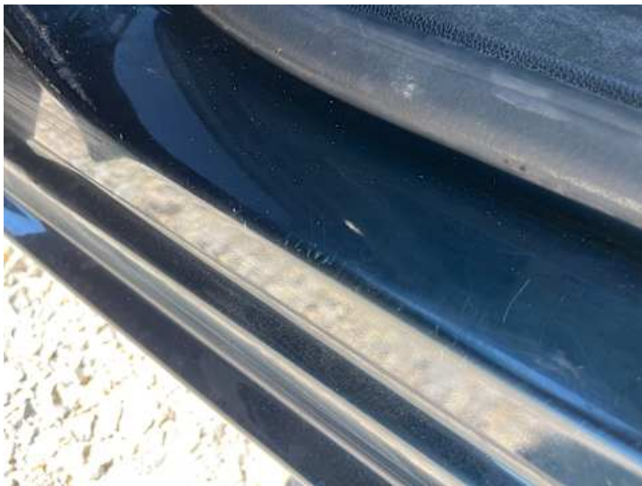
Schweller links (Lackschaden, Kratzer)
