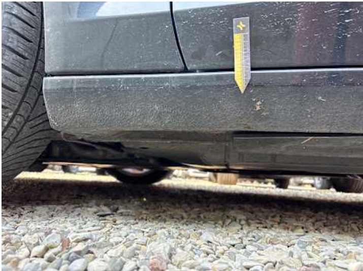
Schweller links (Verformung)
