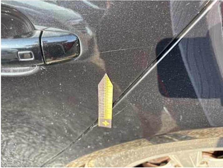
Türe hinten links (Kratzer)
