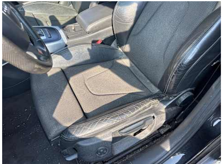
Innenraum (Verschleiß, Verschmutzung)
