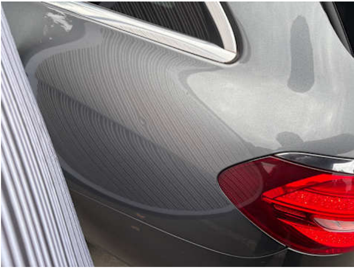
Seitenteil hinten links (Delle)
