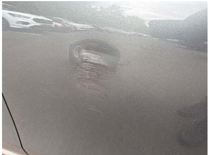
Fahrtür (Unsachgemäß instand gesetzt, Delle)
