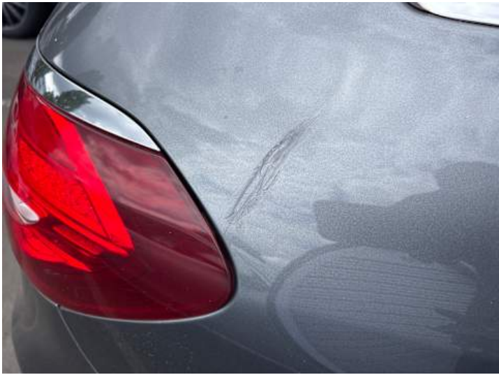
Seitenteil hinten rechts (Unsachgemäß instand gesetzt)
