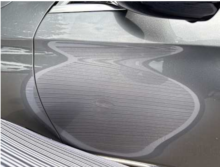
Fahrtür (Unsachgemäß instand gesetzt, Delle)
