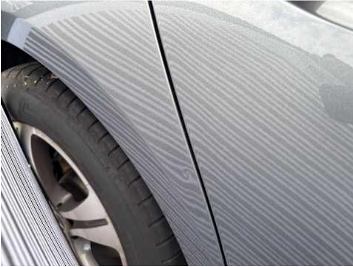
Seitenteil hinten rechts (Delle)
