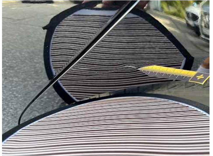
Seitenteil hinten links (Kratzer, Lackschaden, Delle)
