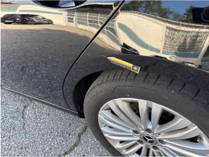
Seitenteil hinten links (Kratzer, Lackschaden, Delle)
