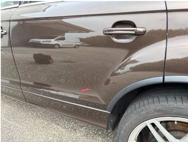
Türe hinten links (Rost)
