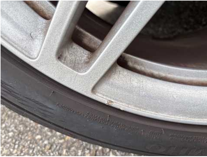
Rad (Kerben, Kratzer, Riss/Bruch)
