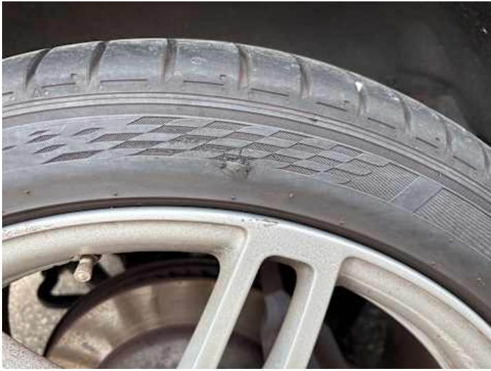
Rad (Kerben, Kratzer, Riss/Bruch)
