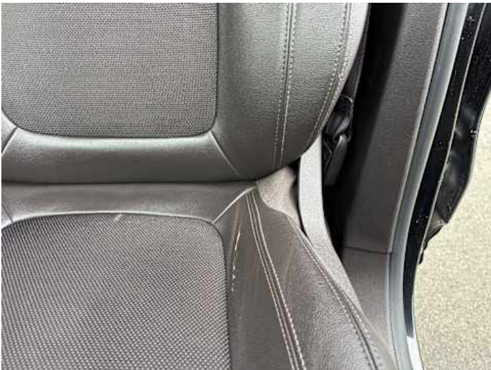
Innenraum (Verschleiß, Riss/Bruch)
