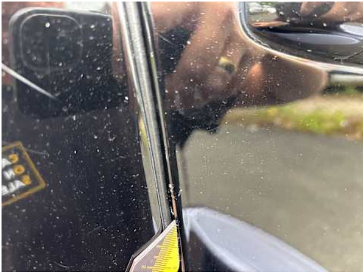
Beifahrertür (Kratzer, Rost)
