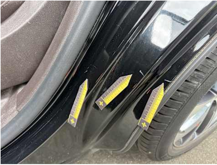
Türe hinten links (Kratzer)
