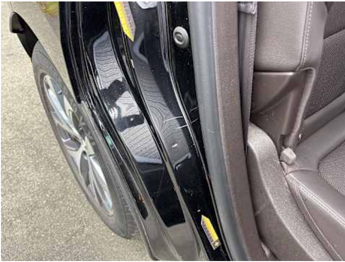
Türe hinten rechts (Delle, Kratzer)
