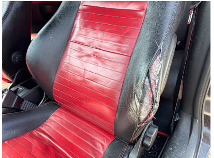
Innenraum (Riss/Bruch, Verschleiß)
