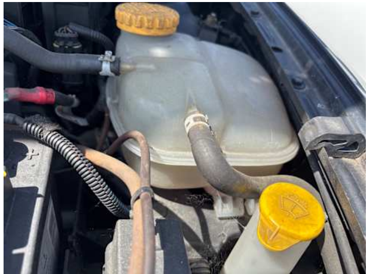
Motorhaube (Anderer Schaden): Kühlmittelstand zu gering,
