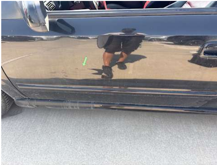
Fahrtür (Delle, Riss/Bruch, Lackschaden)
