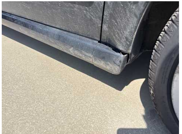
Schweller rechts (Riss/Bruch, Spaltmaße ungenau)
