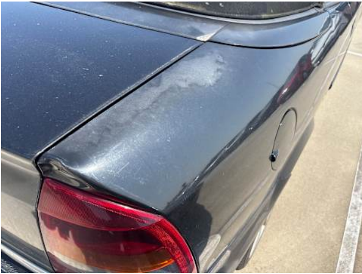
Seitenteil hinten rechts (Delle, Lackschaden, Ausgeblichen/Matt)
