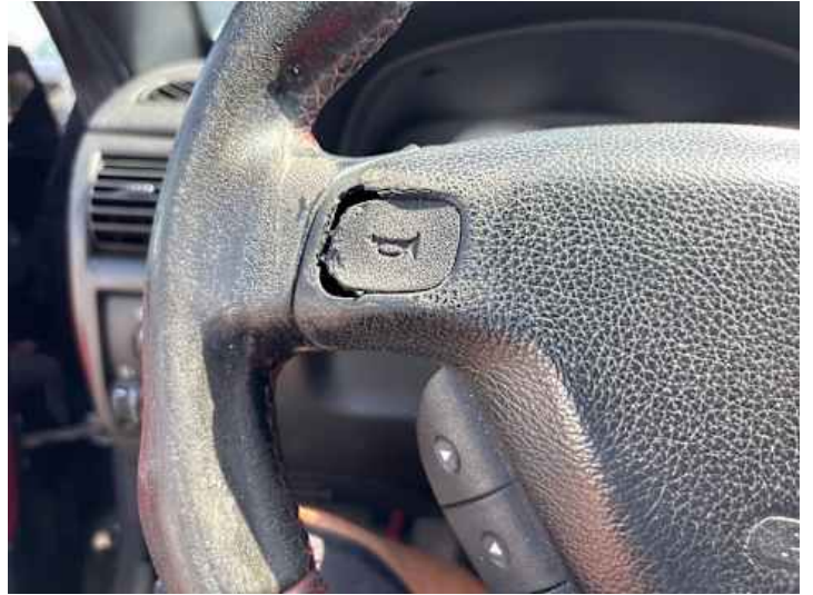
Innenraum (Verschleiß, Riss/Bruch)
