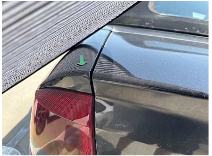
Seitenteil hinten links (Unsachgemäß instand gesetzt, Delle, Ausgeblichen/Matt)
