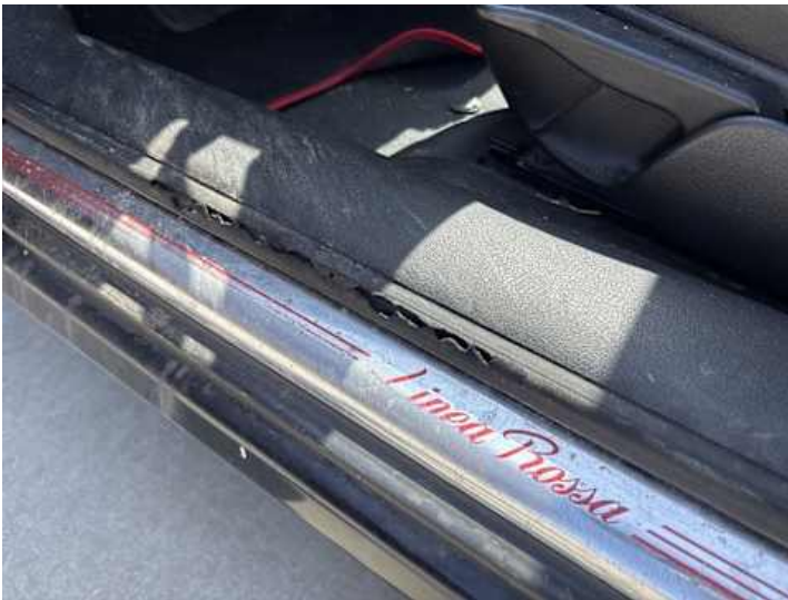
Innenraum (Riss/Bruch, Verschleiß)
