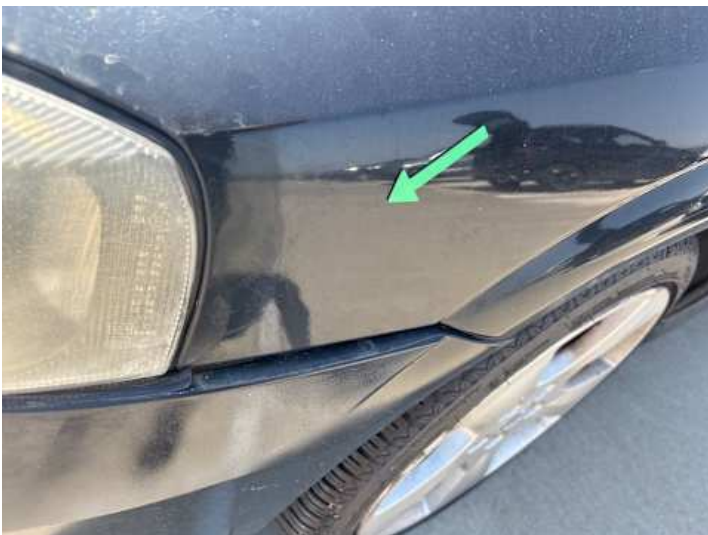
Kotflügel vorne links (Unsachgemäß instand gesetzt)
