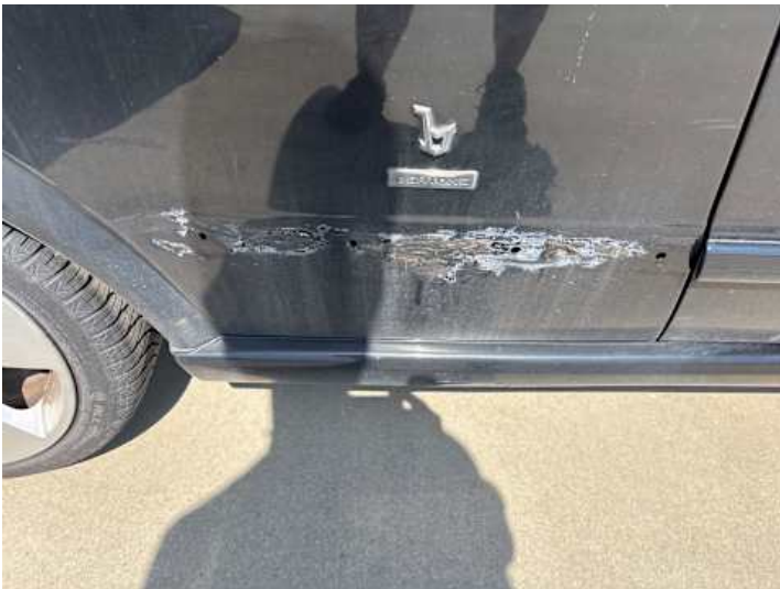
Seitenteil hinten rechts (Anderer Schaden, Unsachgemäß instand gesetzt): Leiste fehlt,
