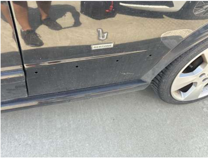
Seitenteil hinten links (Anderer Schaden): Leiste fehlt,
