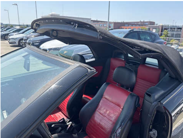
Innenraum (Anderer Schaden): Verdeck öffnet nicht mehr selbstständig,
