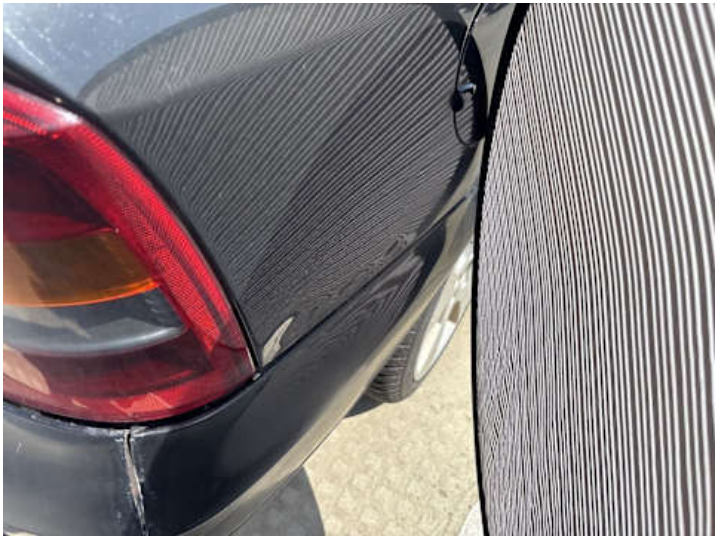
Seitenteil hinten rechts (Delle, Lackschaden, Ausgeblichen/Matt)
