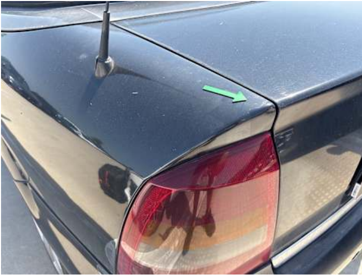
Seitenteil hinten links (Unsachgemäß instand gesetzt, Delle, Ausgeblichen/Matt)
