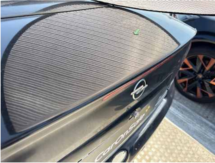
Heckklappe (Unsachgemäß instand gesetzt)
