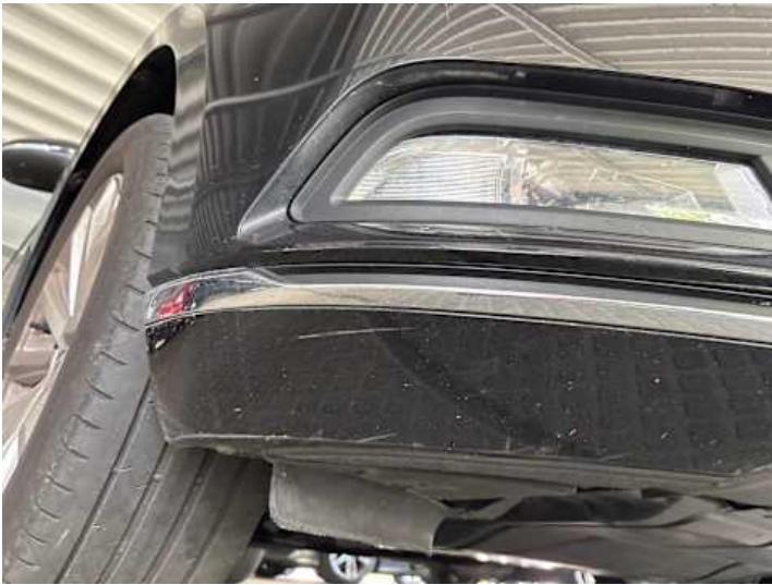
Stoßstange vorne (Lackschaden, Kratzer)
