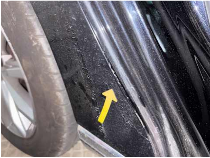
Seitenteil hinten rechts (Lackschaden)
