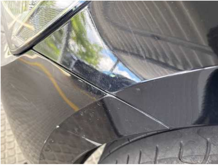
Kotflügel vorne links (Lackschaden)
