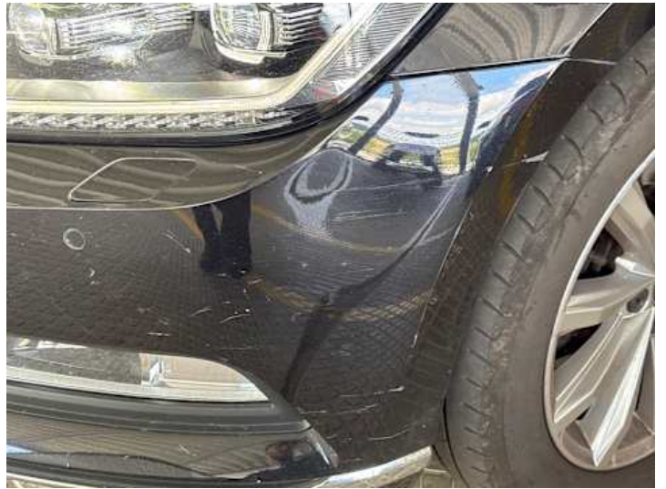
Stoßstange vorne (Lackschaden, Kratzer)
