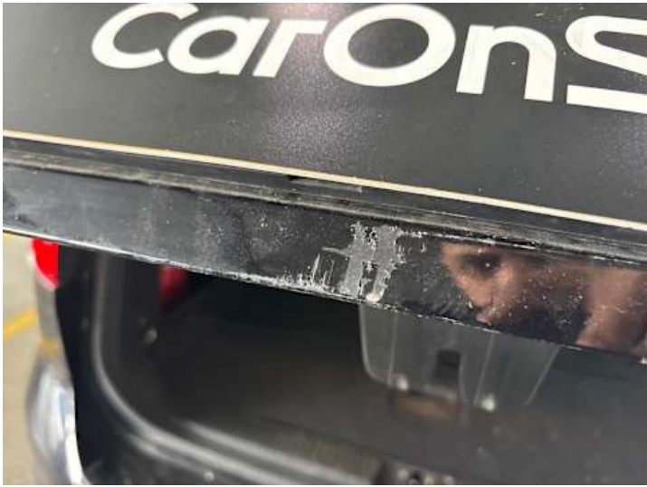
Heckklappe (Lackschaden, Kratzer)
