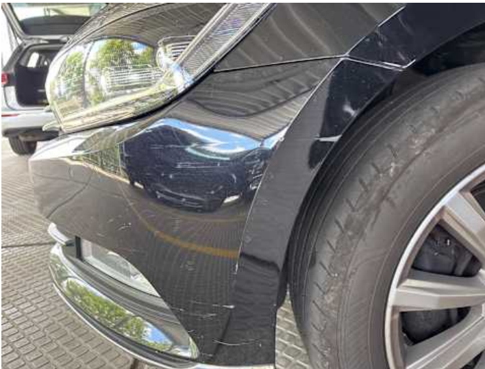
Stoßstange vorne (Lackschaden, Kratzer)
