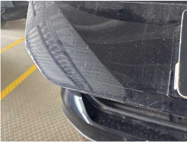
Heckklappe (Lackschaden, Kratzer)
