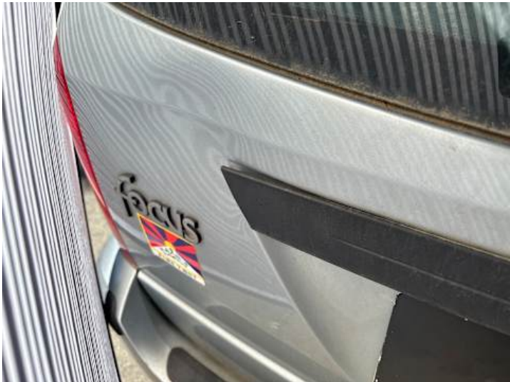
Heckklappe (Verformung, Kratzer)
