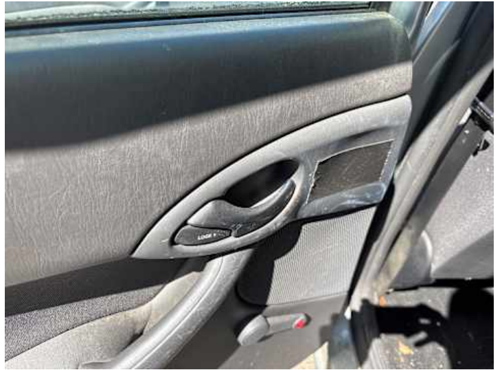
Innenraum (Verschmutzung, Tierhaare/Tiergeruch, Diverse Schäden, Riss/Bruch)
