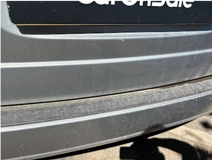
Heckklappe (Verformung, Kratzer)
