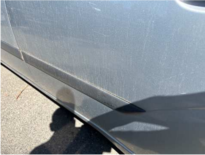
Türe hinten links (Kratzer)
