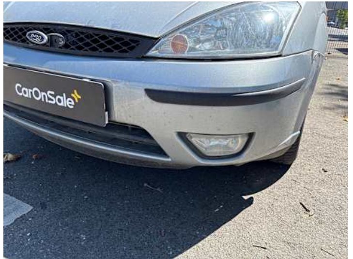
Stoßstange vorne (Kratzer, Riss/Bruch, Spaltmaße ungenau)
