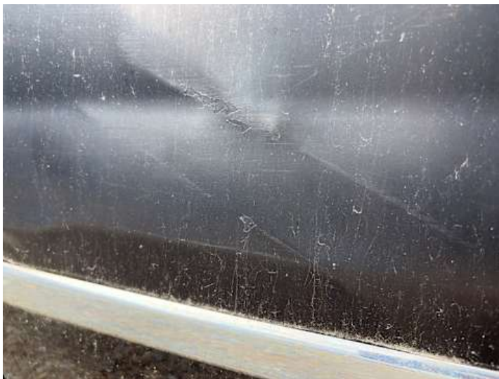
Türe hinten links (Lackschaden)
