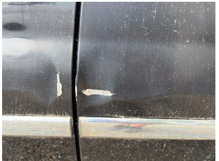
Türe hinten links (Lackschaden, Verformung)
