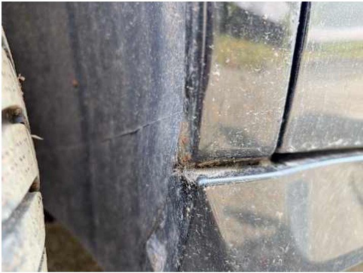
Seitenteil hinten rechts (Rost)
