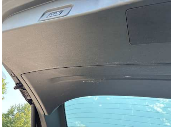
Innenraum (Kratzer, Verschmutzung)
