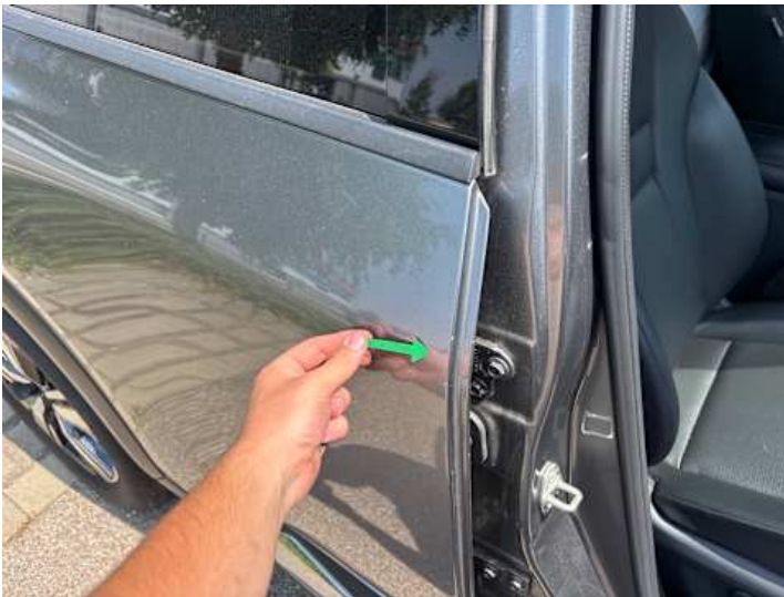
Türe hinten rechts (Lackschaden)
