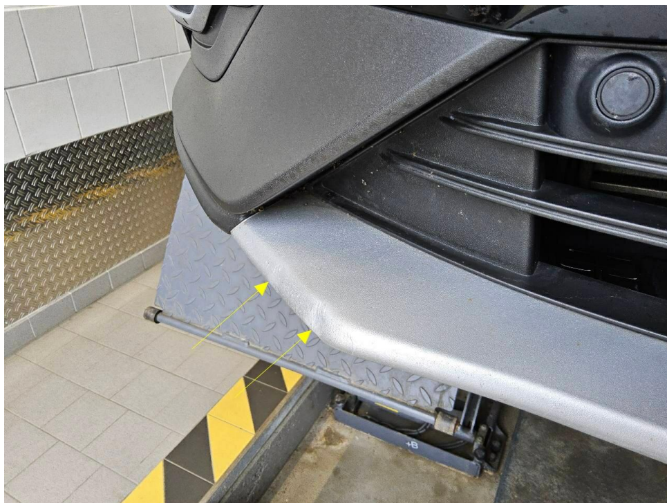
Bild 24 : Gebrauchsspuren, mehrere Kratzer und Dellen rundum
