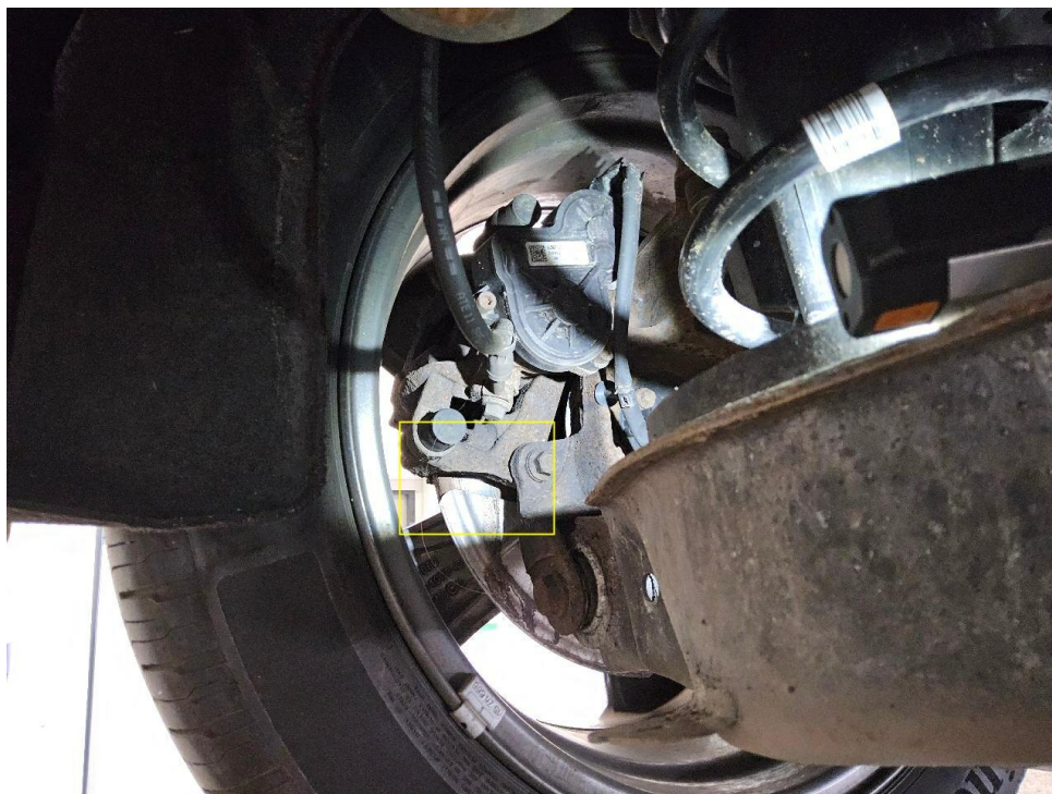
Bild 27 : Bremsscheiben hinten rechts und links, Tragbild beachten
