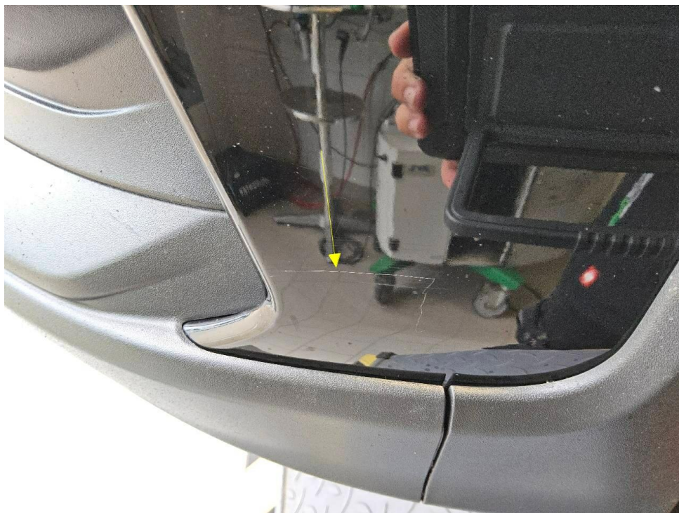
Bild 26 : Gebrauchsspuren, mehrere Kratzer und Dellen rundum
