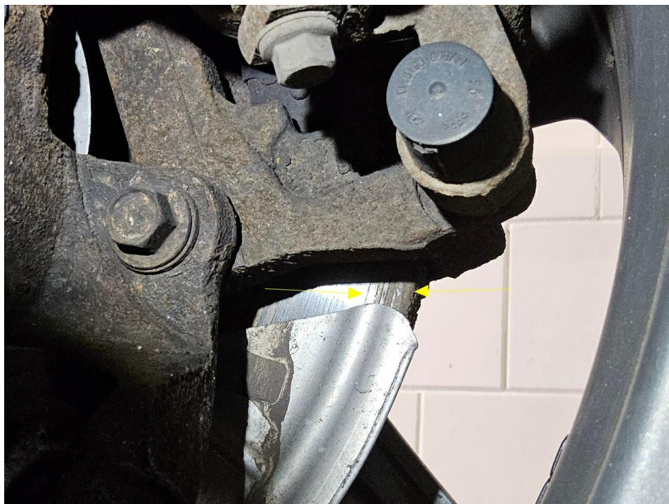
Bild 30 : Bremsscheiben hinten rechts und links, Tragbild beachten
