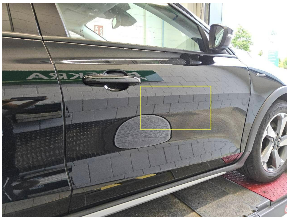
Bild 20 : Gebrauchsspuren, mehrere Kratzer und Dellen rundum
