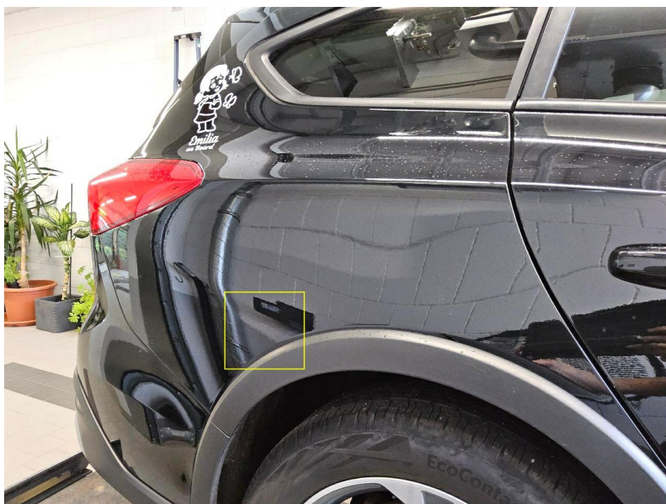
Bild 18 : Gebrauchsspuren, mehrere Kratzer und Dellen rundum
