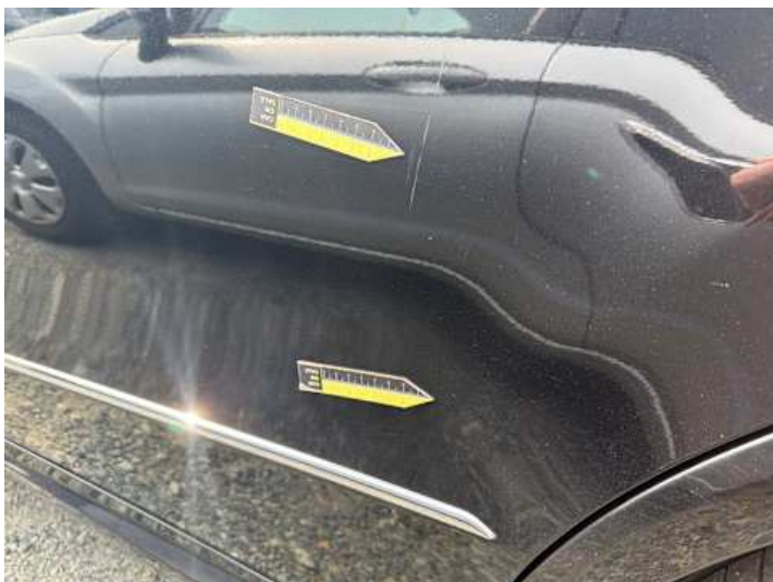
Türe hinten links (Kratzer, Rost)
