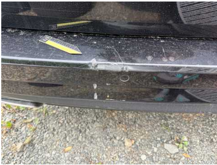
Stoßstange hinten (Verformung, Riss/Bruch)
