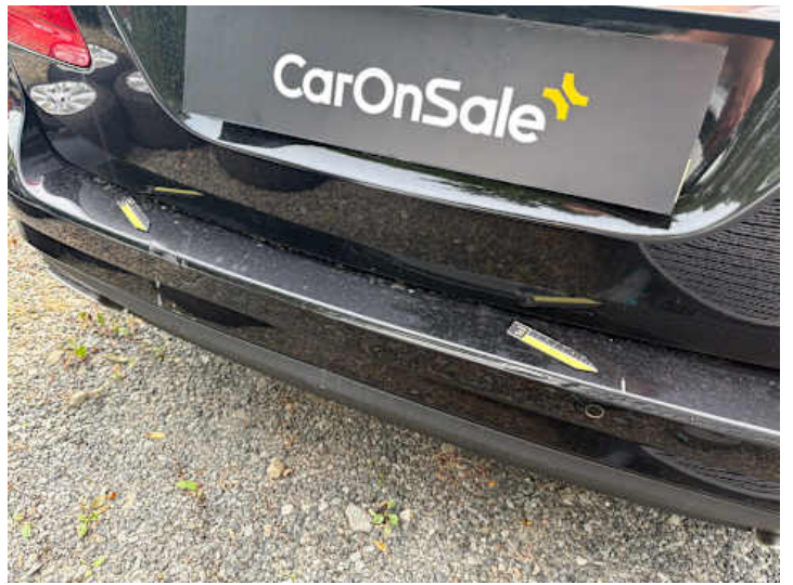
Stoßstange hinten (Verformung, Riss/Bruch)
