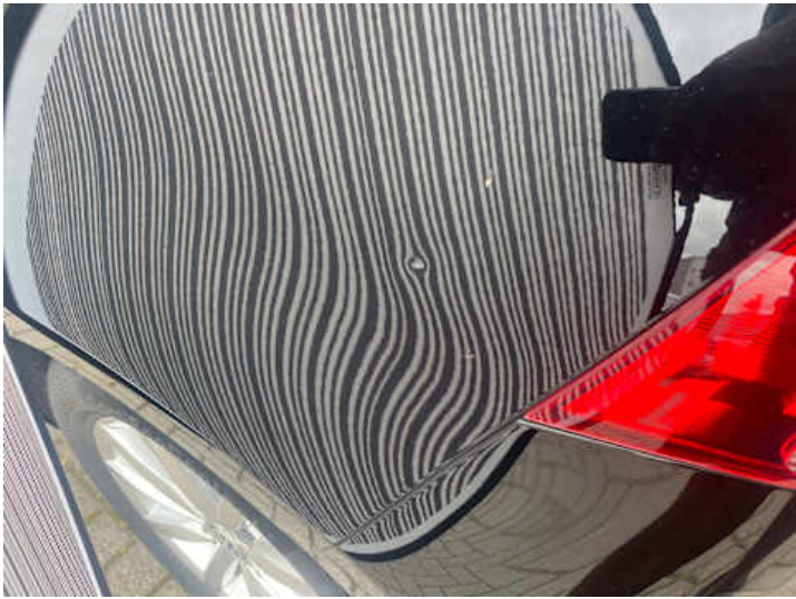
Seitenteil hinten links (Delle)
