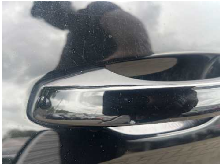
Fahrtür (Kratzer, Lackschaden)
