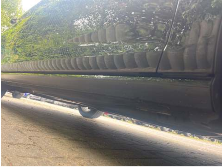
Schweller rechts (Verformung)
