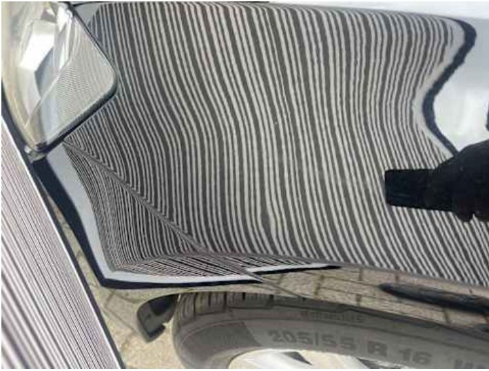
Kotflügel vorne links (Delle)
