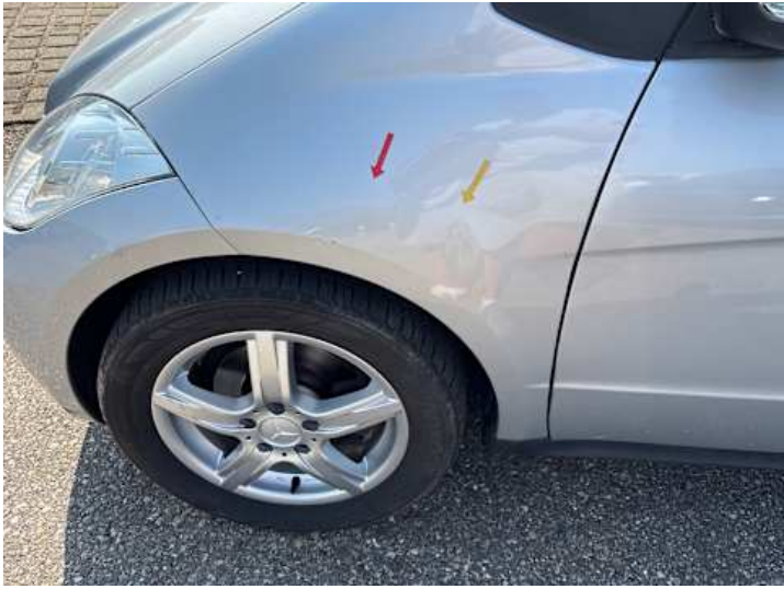
Kotflügel vorne links (Verformung)
