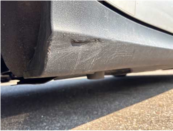
Schweller rechts (Kratzer, Verformung)
