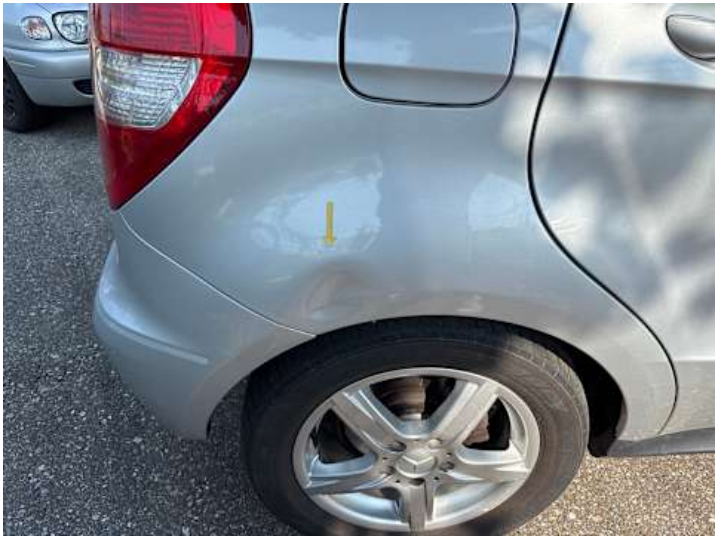
Seitenteil hinten rechts (Verformung)
