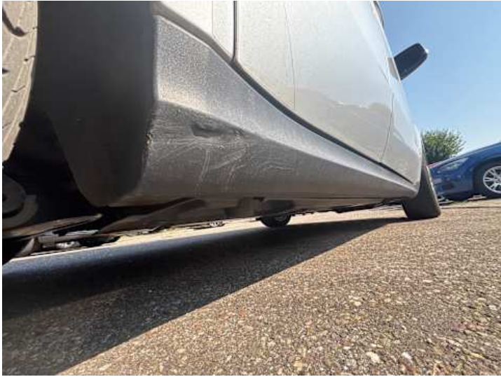
Schweller rechts (Kratzer, Verformung)
