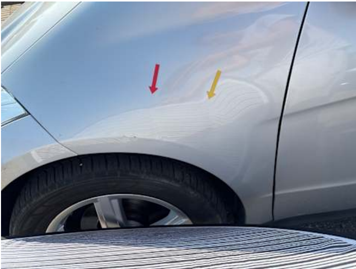
Kotflügel vorne links (Verformung)
