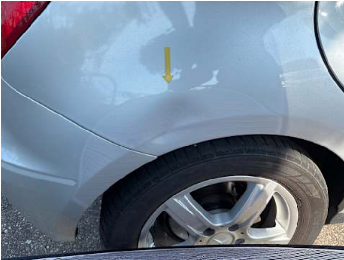
Seitenteil hinten rechts (Verformung)
