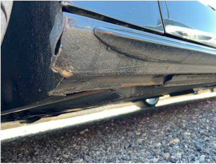
Schweller links (Verformung, Kratzer, Lackschaden)
