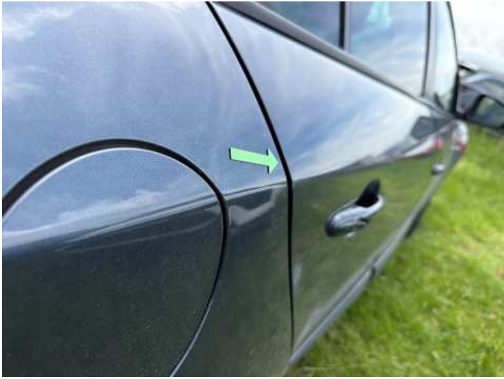
Türe hinten rechts (Spaltmaße ungenau)
