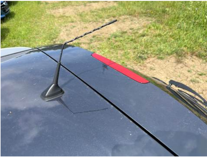
Dach (Anderer Schaden): Antenne gebrochen
