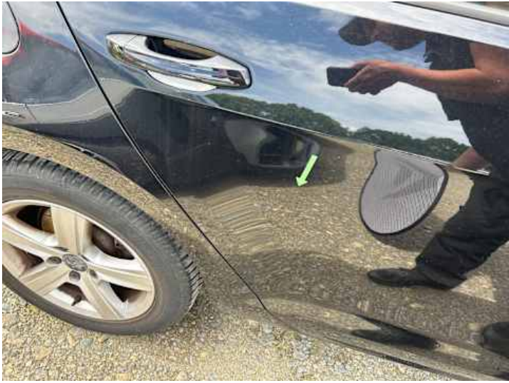
Türe hinten rechts (Delle)
