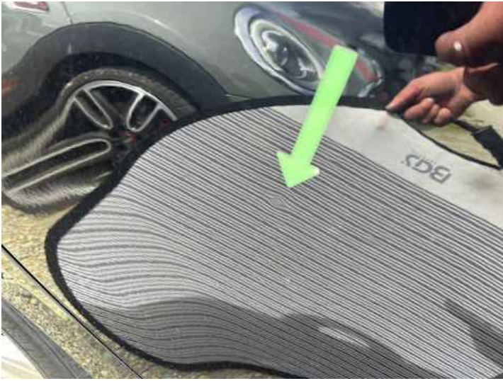
Türe hinten rechts (Delle)
