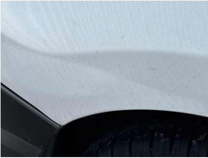
Seitenteil hinten rechts (Verformung)
