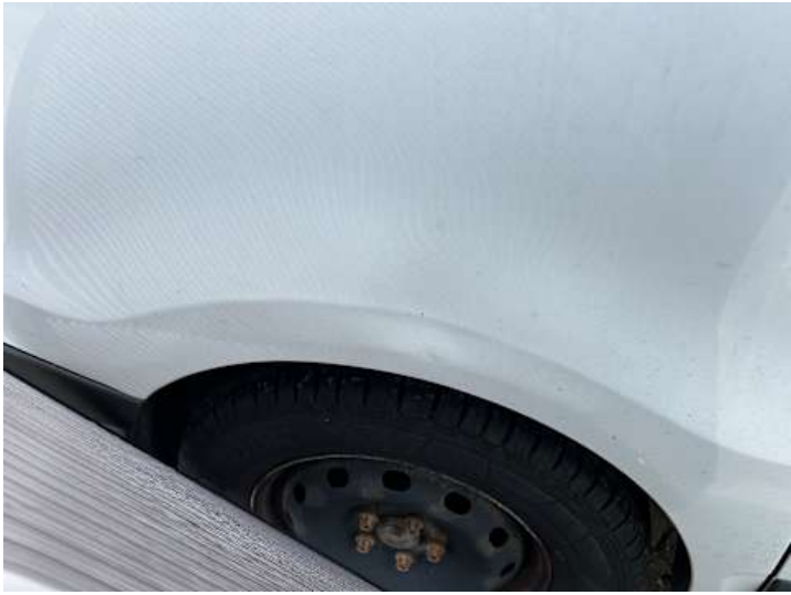
Seitenteil hinten rechts (Verformung)
