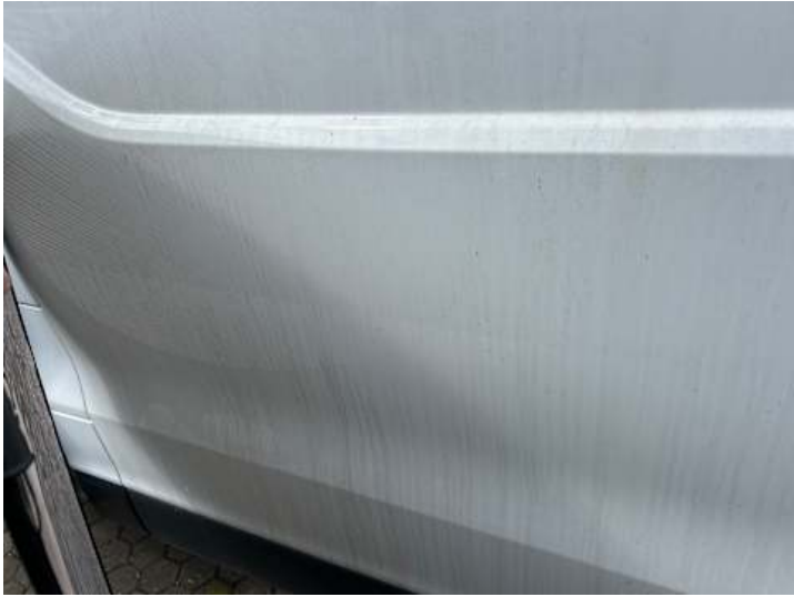
Seitenteil hinten links (Verformung)
