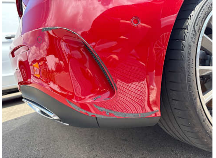
Stoßstange hinten (Anderer Schaden): Carbon Teile fehlen
