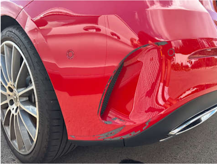
Stoßstange hinten (Anderer Schaden): Carbon Teile fehlen
