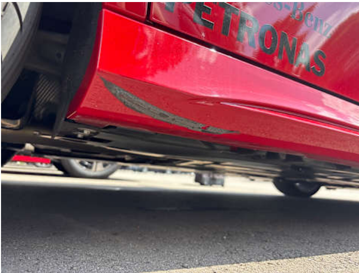
Schweller rechts (Anderer Schaden): Carbon Teile fehlen
