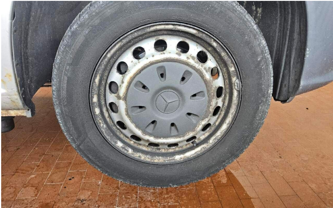
Bild 15 : Felgen 4x, korrodiert
