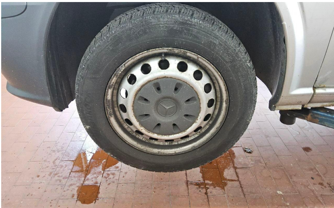
Bild 18 : Felgen 4x, korrodiert
