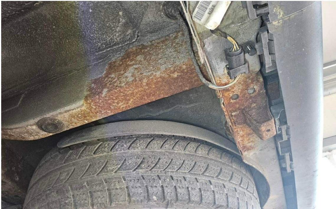
Bild 13 : Unterboden und Achselemente korrodiert
