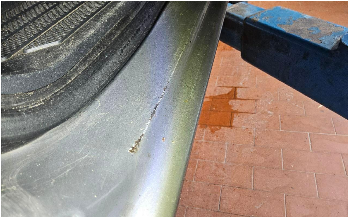
Bild 41 : Einstieg vorne rechts, zerkratzt
