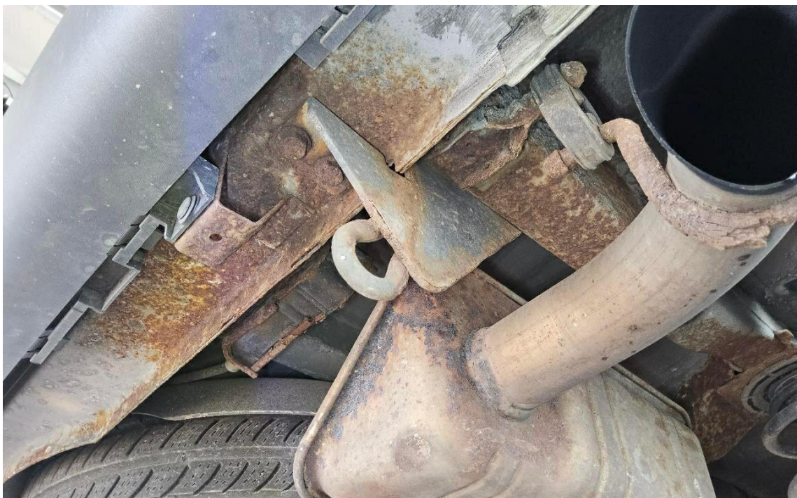
Bild 12 : Unterboden und Achselemente korrodiert
