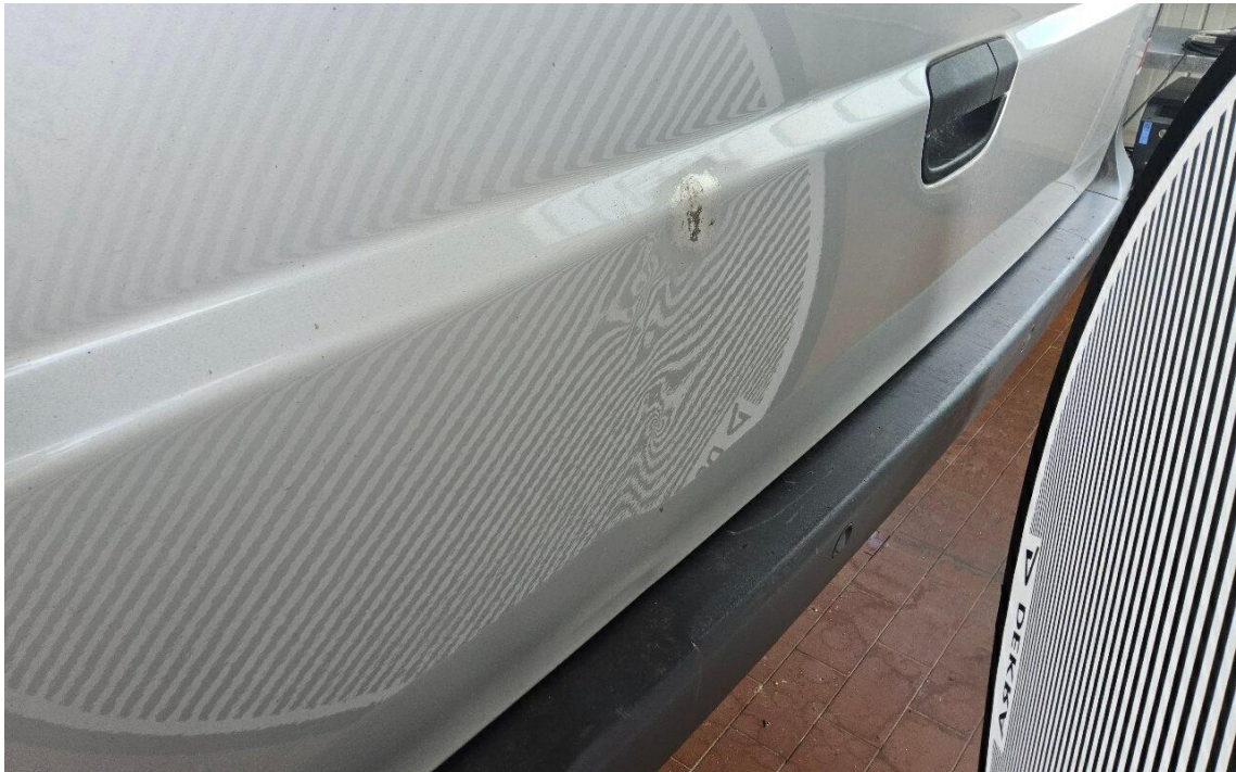
Bild 27 : Kofferraum, keine Sach-und Fachgerechte Lackierung, eingedellt
