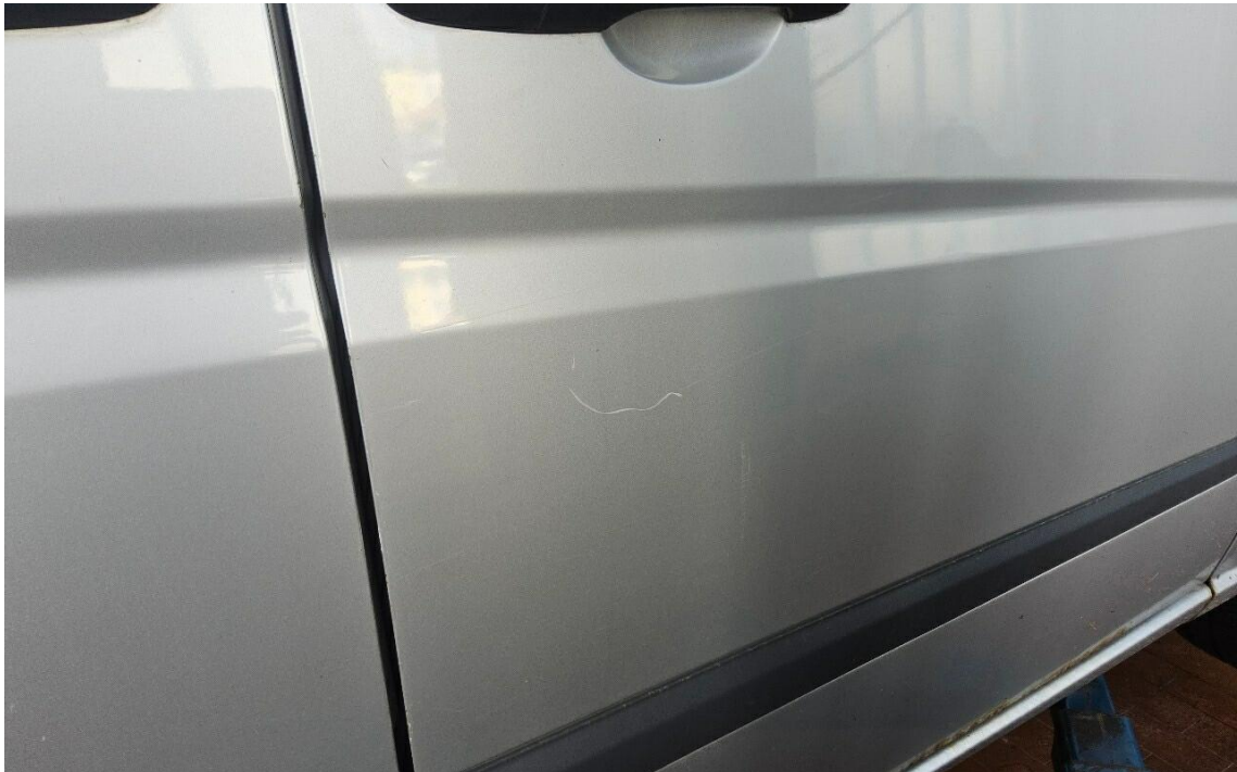
Bild 37 : Tür vorne rechts, zerkratzt
