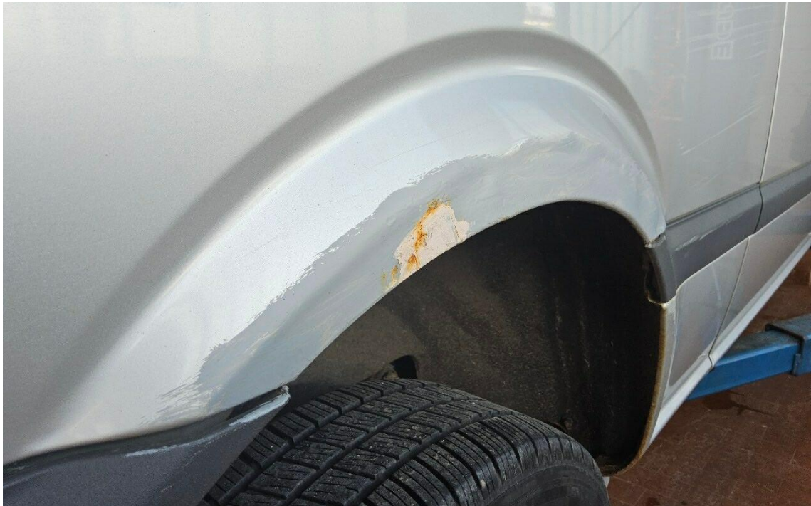
Bild 35 : Seitenwand rechts, eingedellt und zerkratzt
