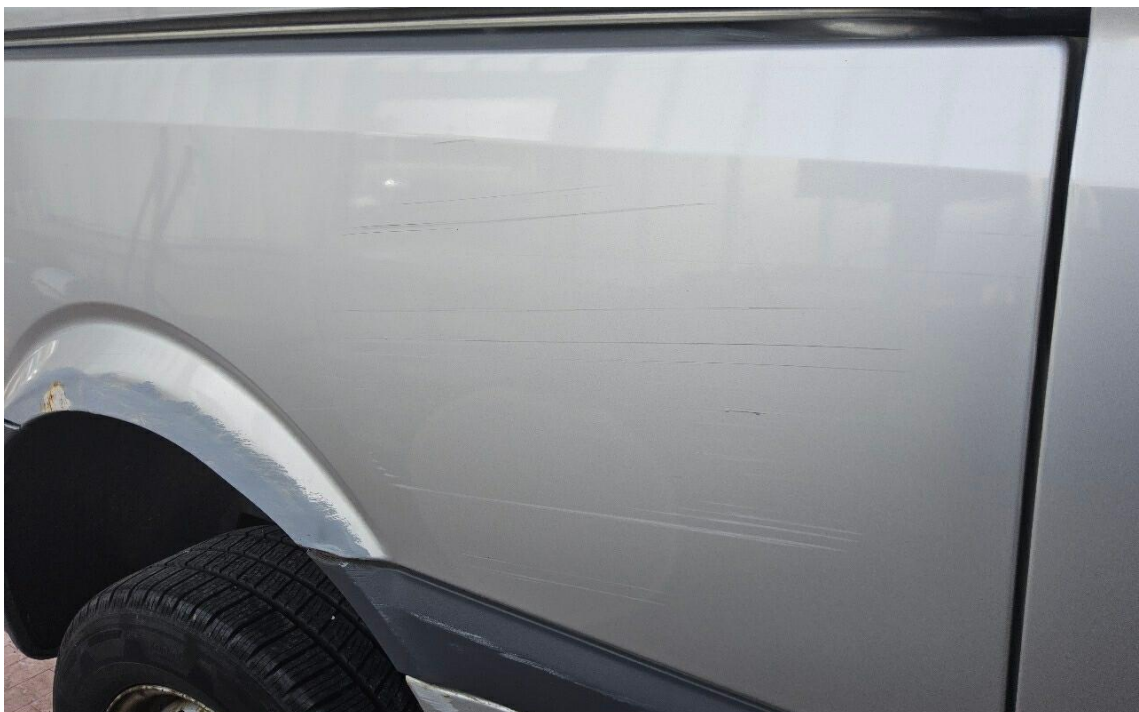
Bild 36 : Seitenwand rechts, eingedellt und zerkratzt
