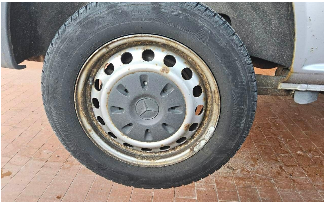
Bild 16 : Felgen 4x, korrodiert
