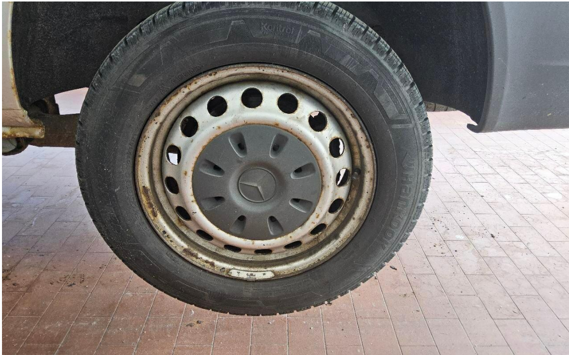
Bild 17 : Felgen 4x, korrodiert
