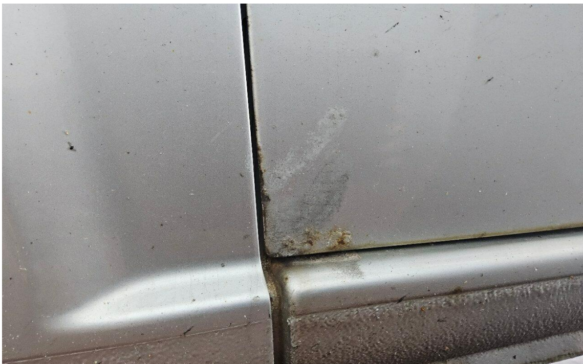
Bild 20 : Tür vorne links, korrodiert
