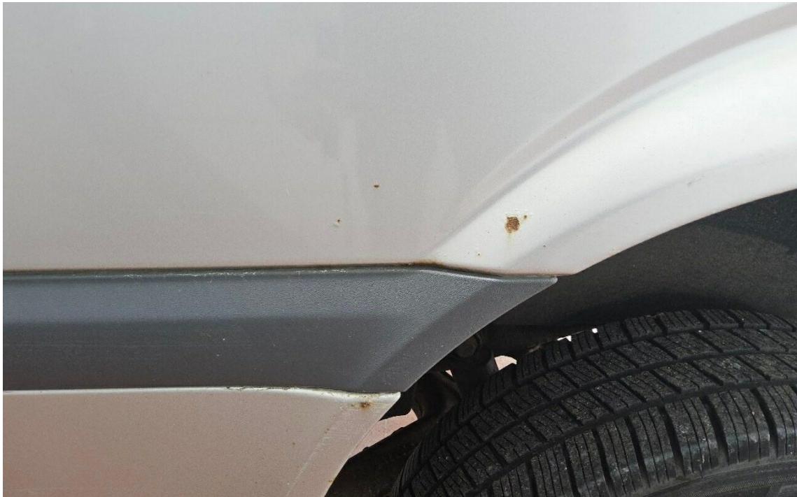
Bild 21 : Seitenwand links, beginnende Korrosion
