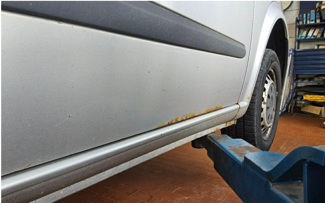
Bild 39 : Tür vorne rechts, zerkratzt, Korrosion
