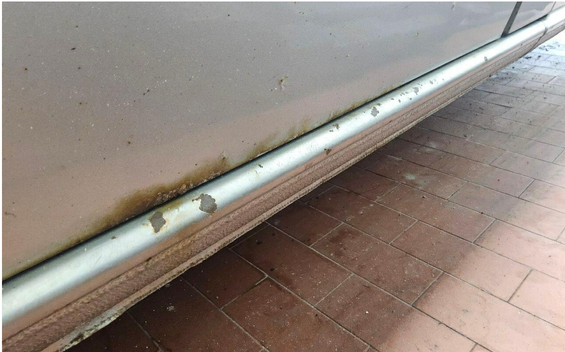
Bild 43 : Einstieg vorne rechts, Korrosion
