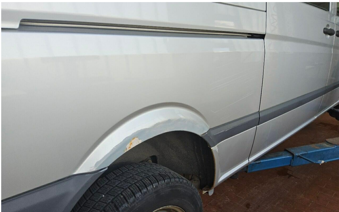
Bild 34 : Seitenwand rechts, eingedellt und zerkratzt
