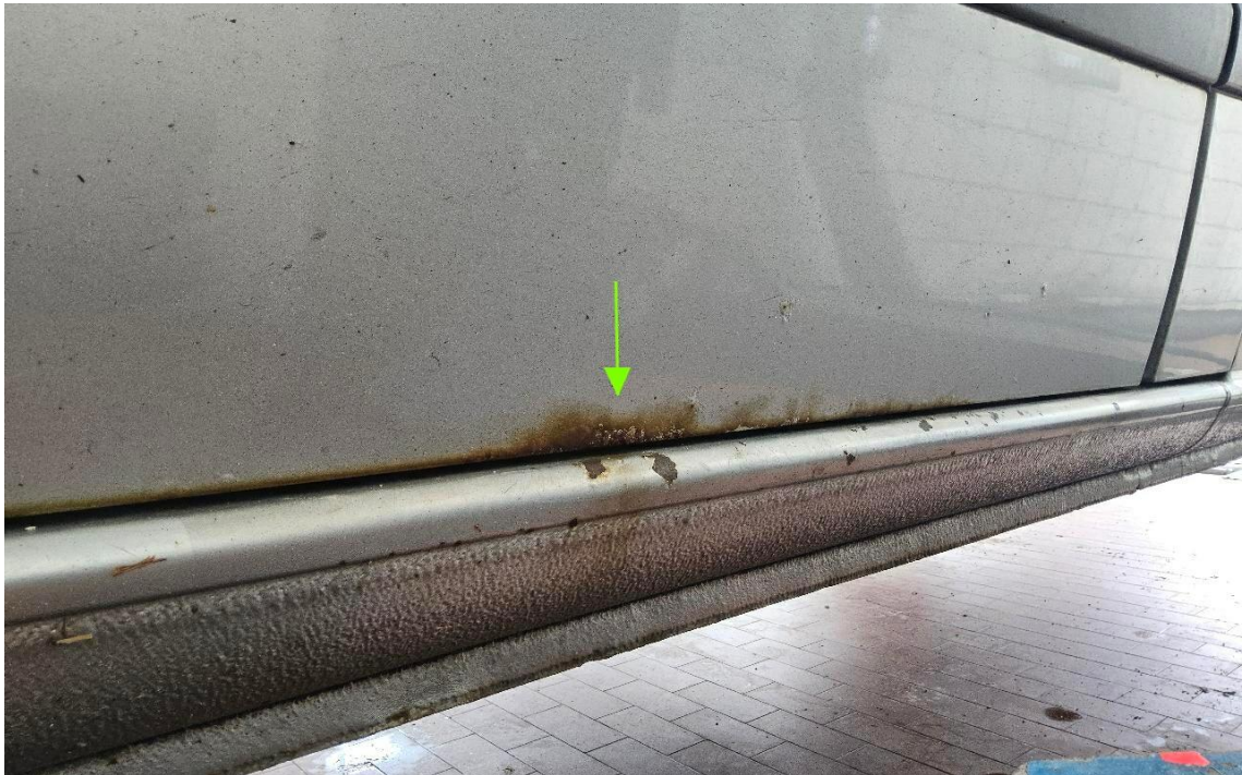
Bild 19 : Tür vorne links, korrodiert
